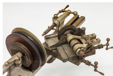
Détail du touret d'affûtage. Phot. Jérôme Mongreville IVR43_20182501260NUC4A
