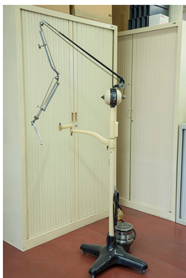
Potence de dentiste Quétin, bras articulé et pièce à main. Phot. Jérôme Mongreville IVR43_20182500870NUC4A
