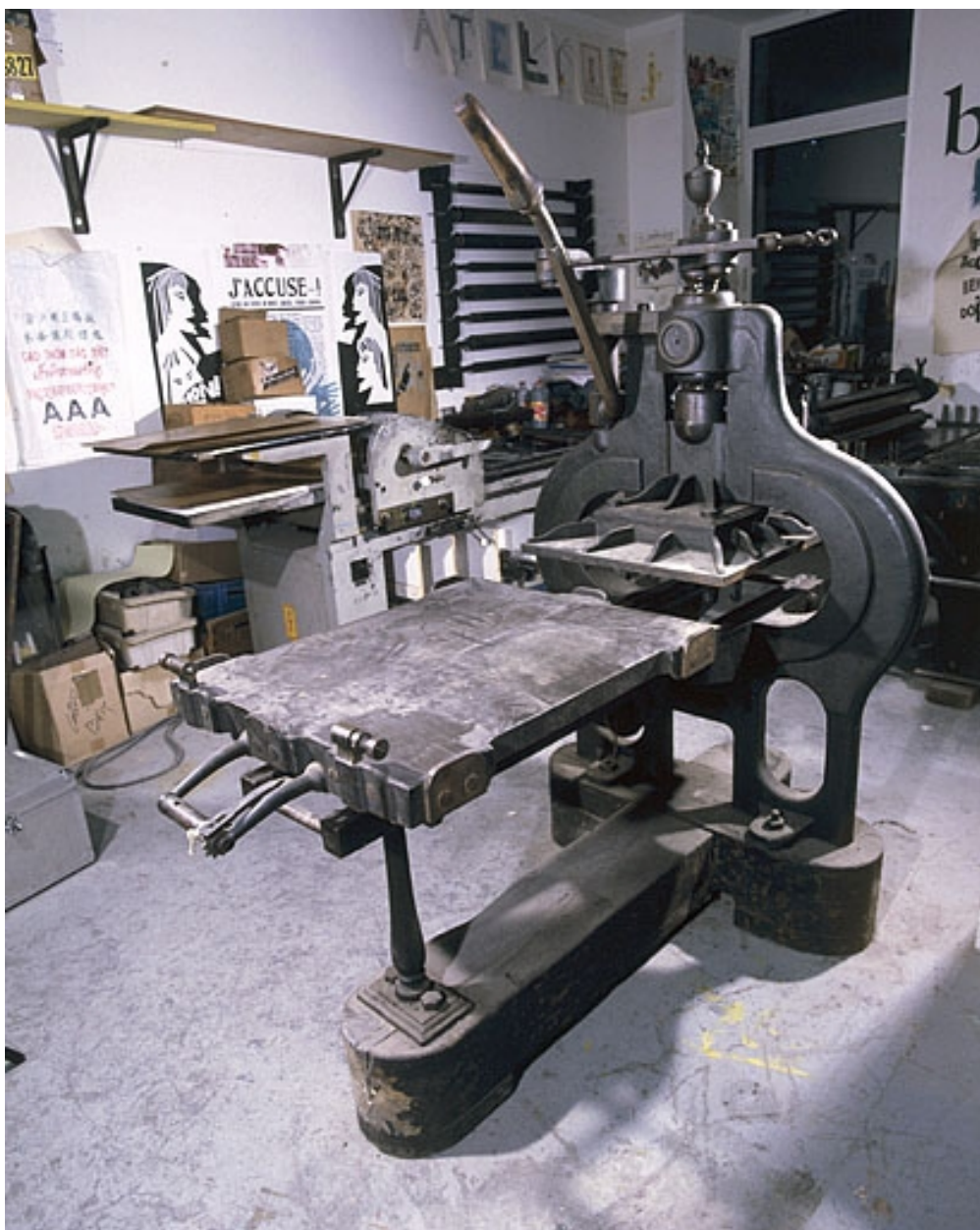
Vue d'ensemble, de trois quarts droite. Le tympan et la frisquette manquent.
