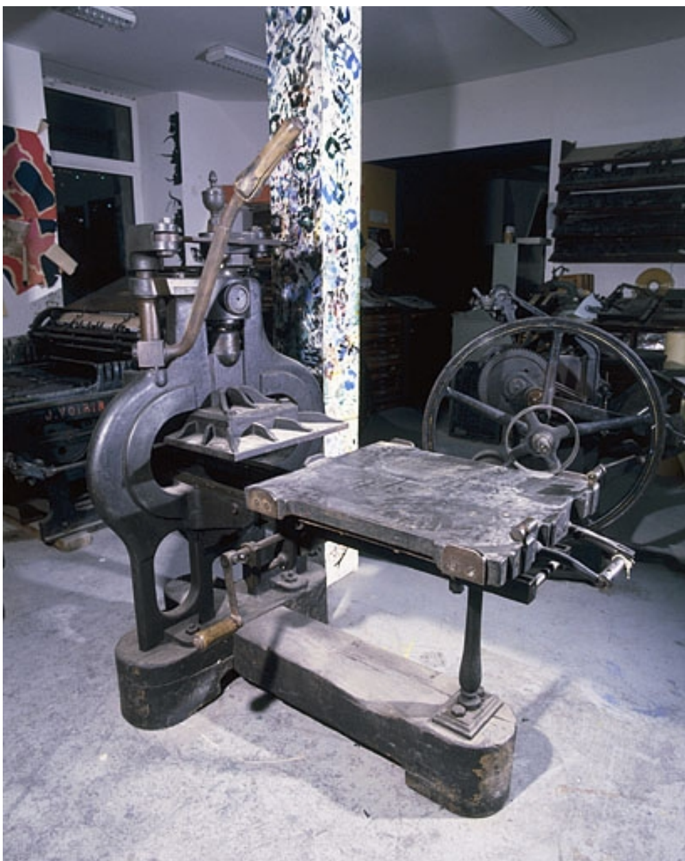
Vue d'ensemble, de trois quarts gauche. Le tympan et la frisquette manquent.
