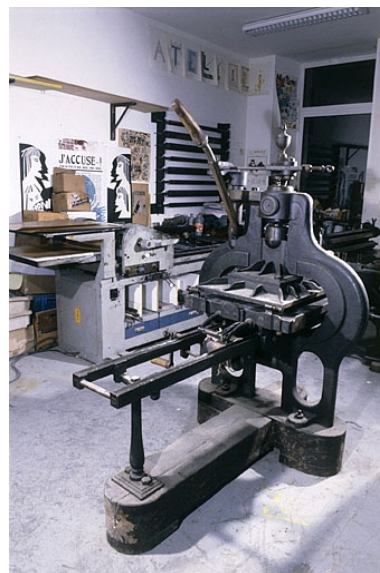
Vue d'ensemble de trois quarts droite, marbre (chariot) sous la platine. Phot. Jérôme Mongreville IVR43_20013900658ZA
