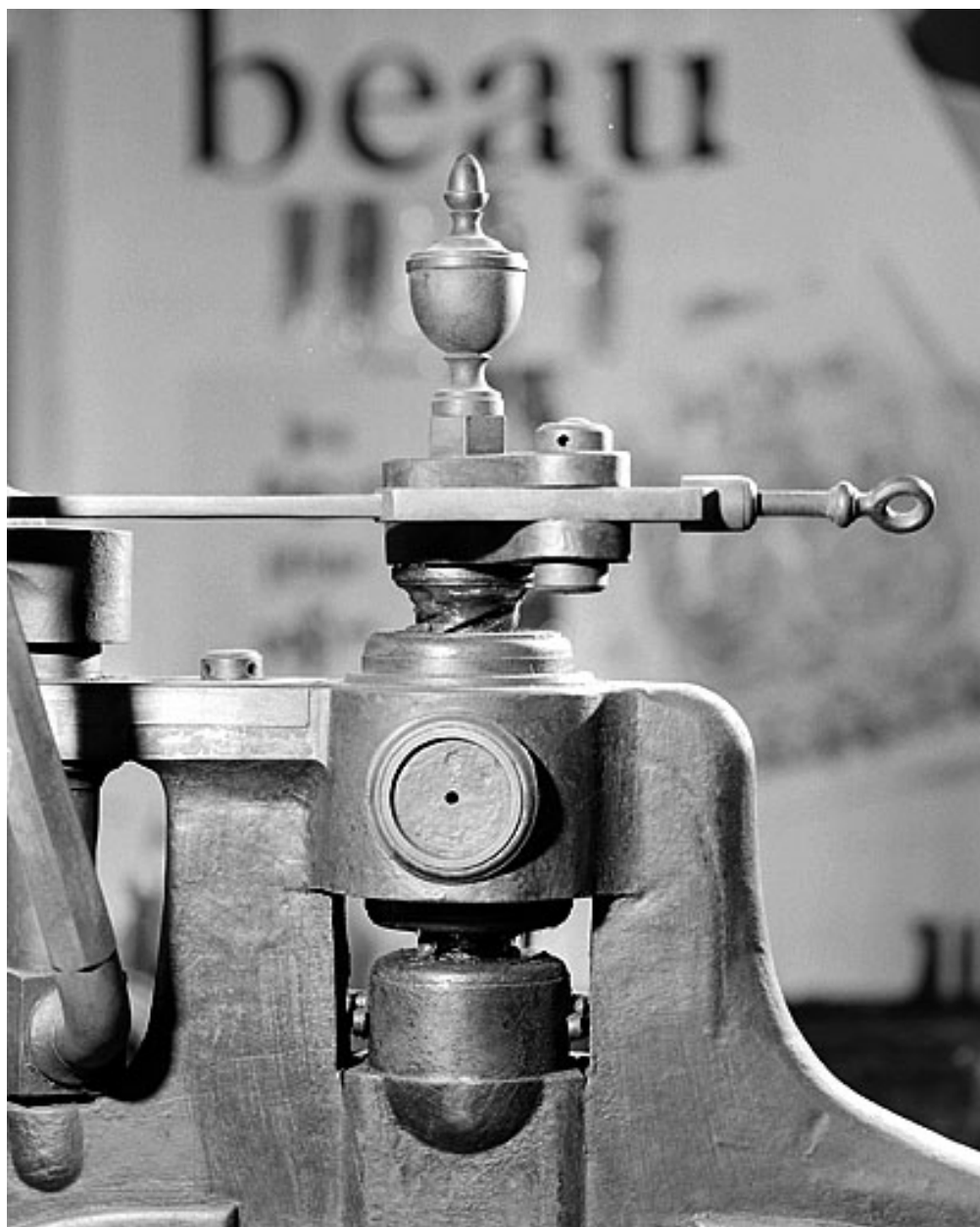
Partie supérieure de la vis, avec le système de transmission du mouvement du barreau.
