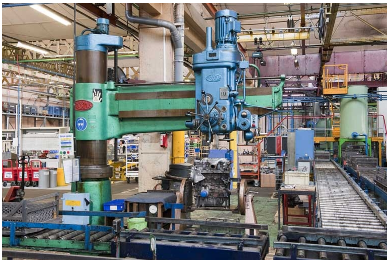
Atelier de rénovation des moteurs. Perceuse Rabora.
