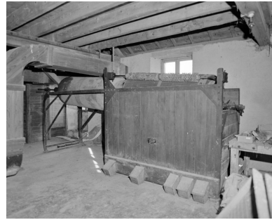
2e étage. Trieur à blé. Phot. Jean-Luc Duthu IVR26_20062106721X
