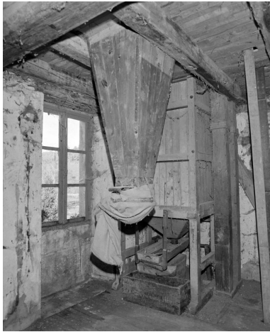
1er étage. Boisseau à farine et ensacheur. Phot. Jean-Luc Duthu IVR26_20062106700X
