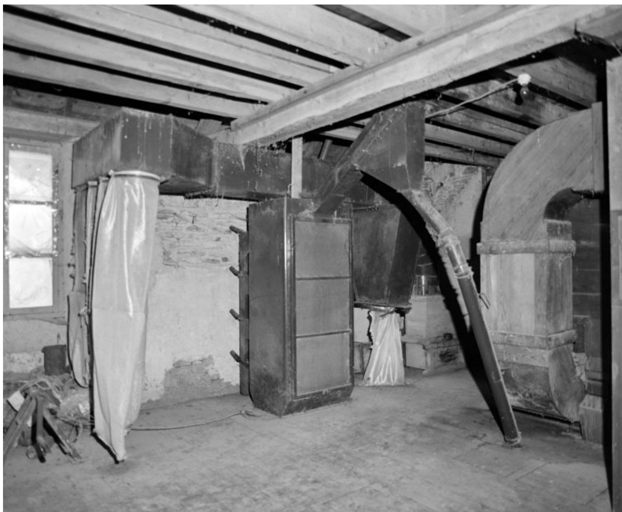
2e étage. Trieur à blé, ensacheur.
