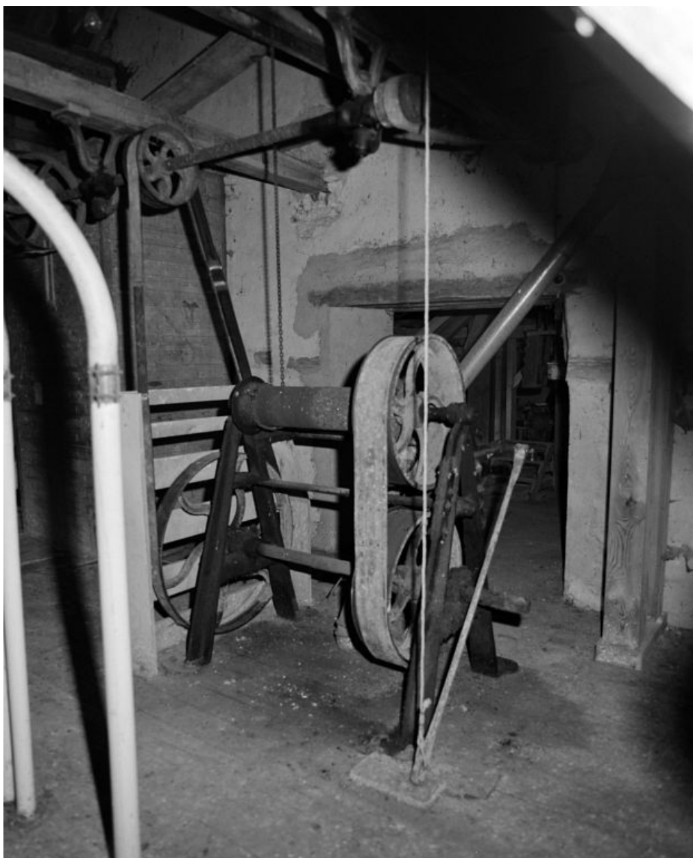
Comble à surcroît. Monte-sacs.
