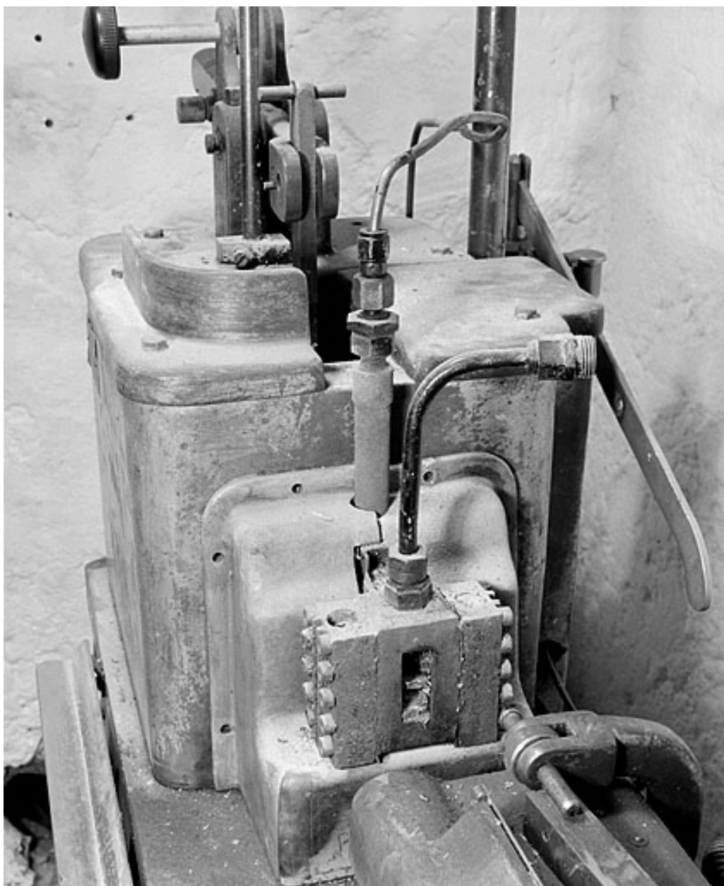
Creuset et bouche d'injection.
