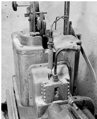
Creuset et bouche d'injection. Phot. Jérôme Mongreville IVR43_20023900359X
