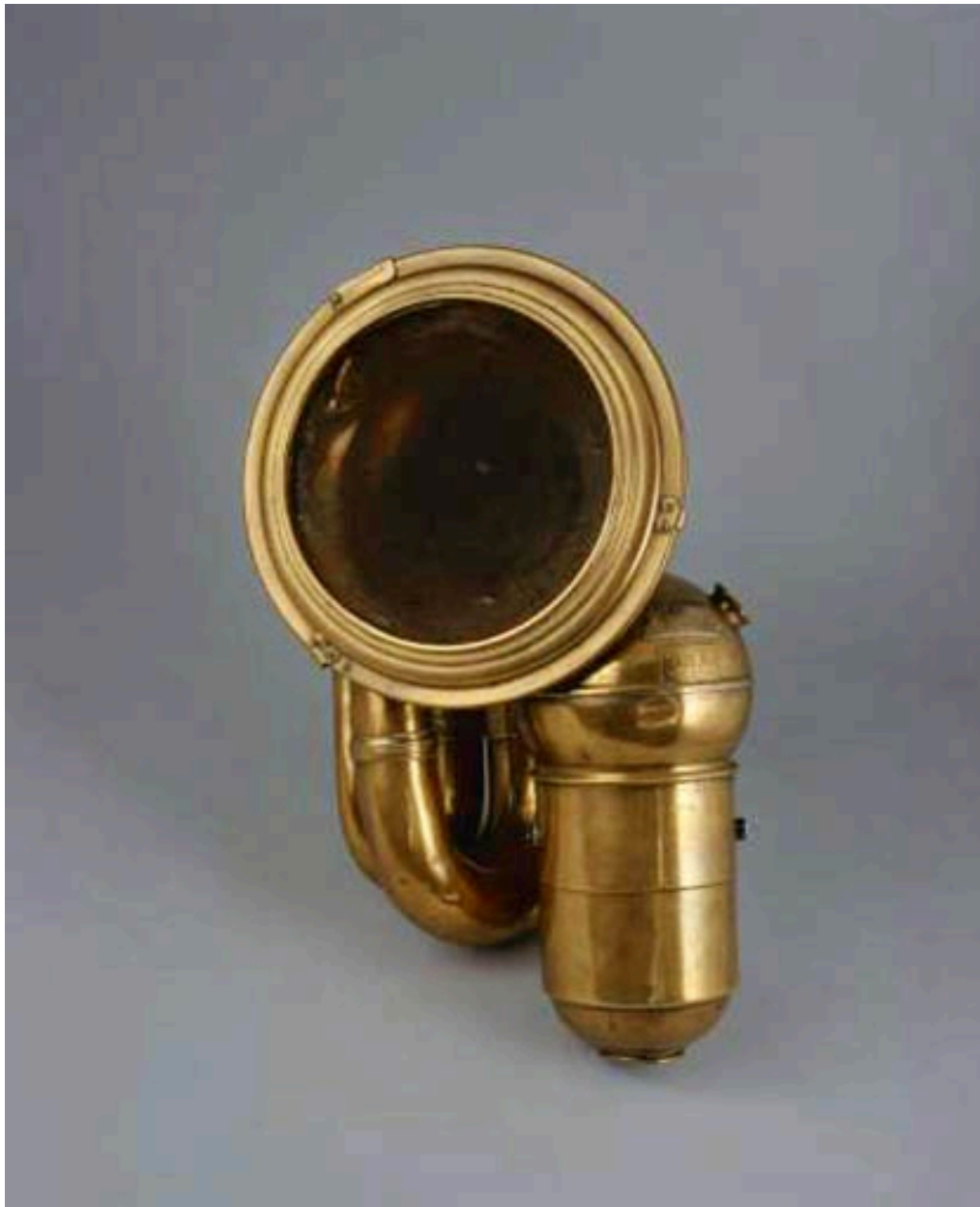
Avertisseur sonore pneumatique pour automobile.
