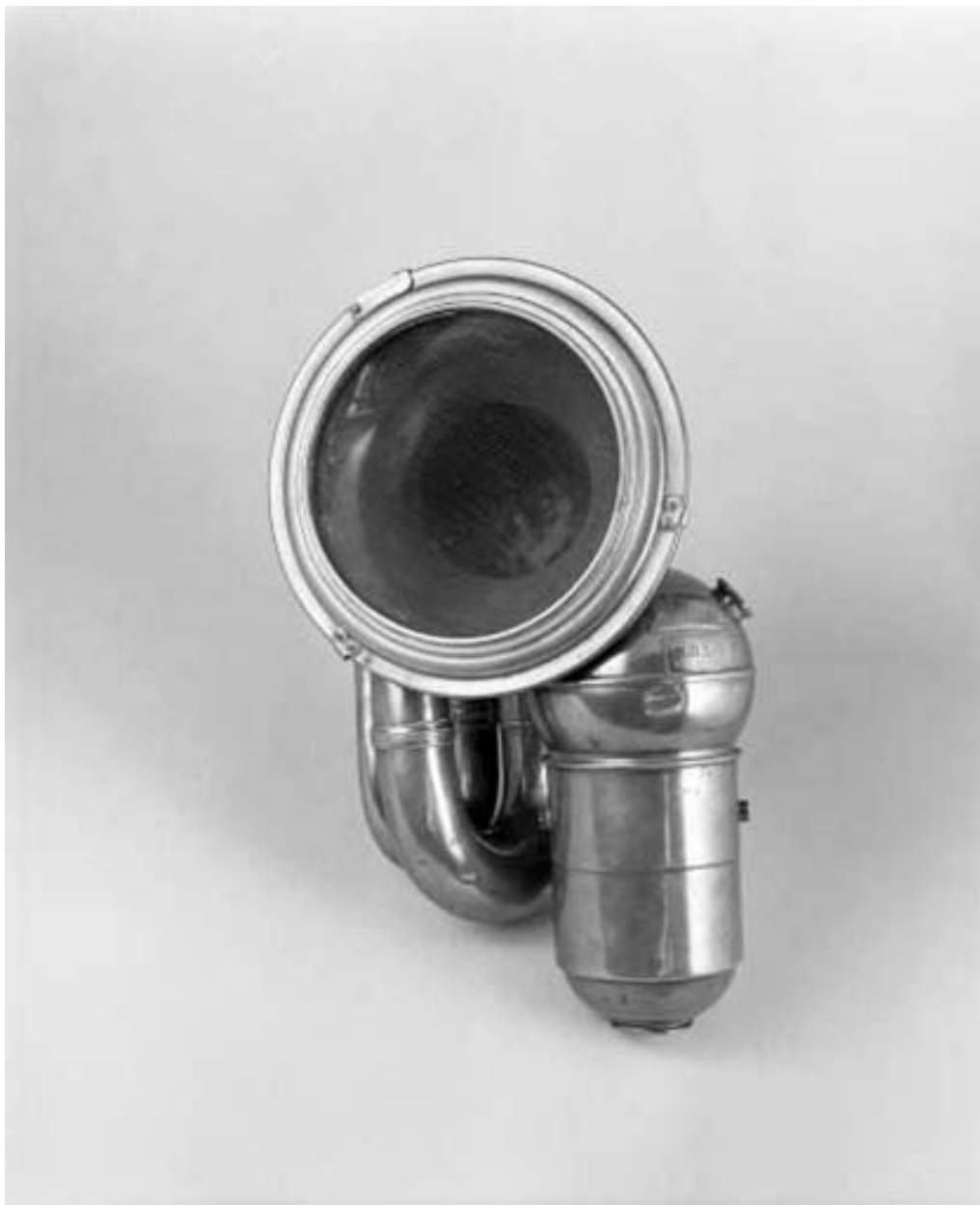
Avertisseur sonore pneumatique pour automobile.
