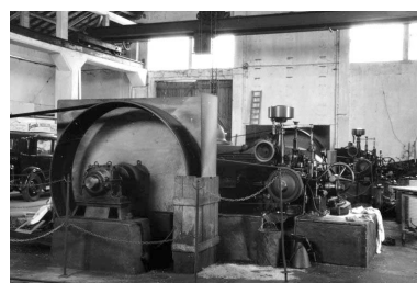
Centrale hydroélectrique, intérieur : transmission de la turbine. Phot. Laurent Poupard IVR43_19883900598Z
