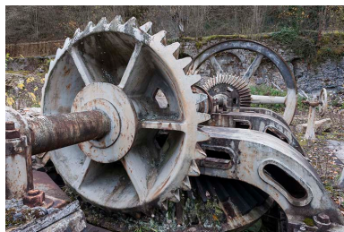
Turbine double. Transmission par engrenage conique. Phot. Jérôme Mongreville IVR43_20152502493NUC4A
