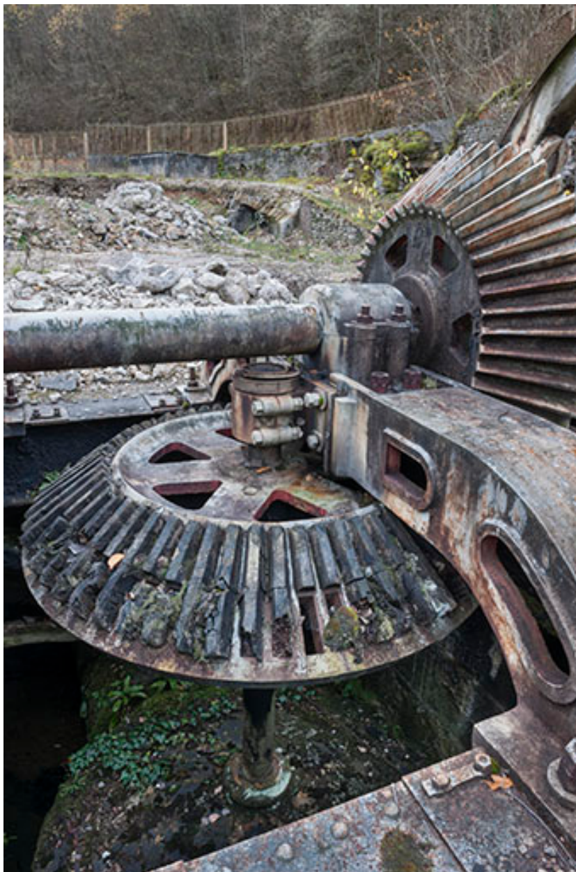
Turbine double. Détail des engrenages coniques.
