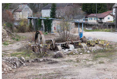
Usine du Moulin-Neuf. Vestiges de la turbine double. Phot. Jérôme Mongreville IVR43_20152502494NUC4A
