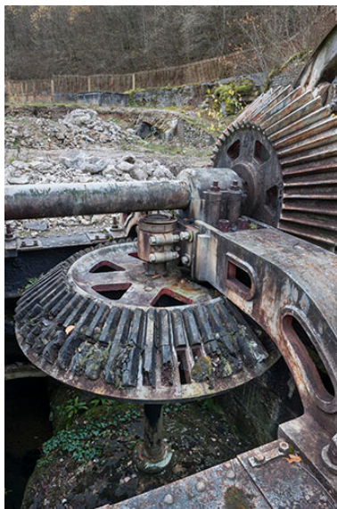
Turbine double. Détail des engrenages coniques. Phot. Jérôme Mongreville IVR43_20152502492NUC4A
