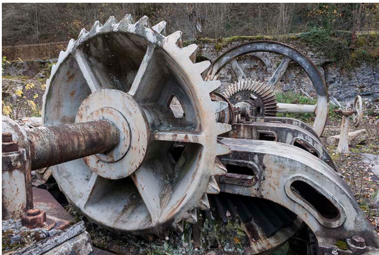
Turbine double. Transmission par engrenage conique.
