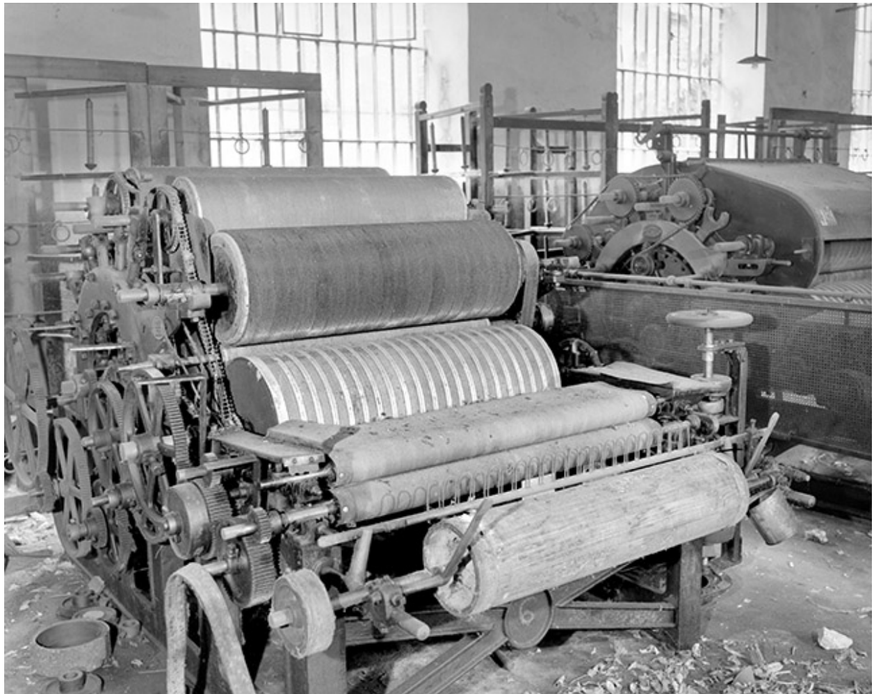
Face arrière vue de trois quarts gauche. Rouleau en bois, guide-fils, manchons frotteurs, cylindre volant et cylindres travailleurs.
