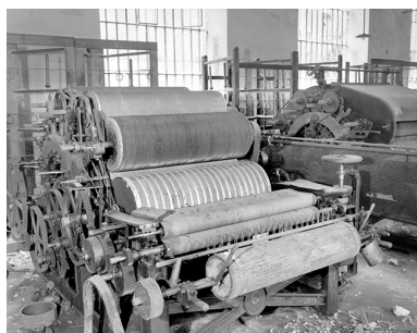
Face arrière vue de trois quarts gauche. Rouleau en bois, guide-fils, manchons frotteurs, cylindre volant et cylindres travailleurs. Phot. Yves Sancey IVR43_19943901532X
