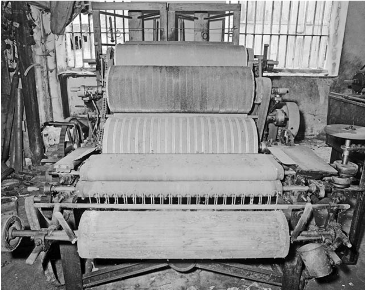
Face arrière. Rouleau en bois, guide-fils, manchons frotteurs, cylindre volant et cylindres travailleurs.
