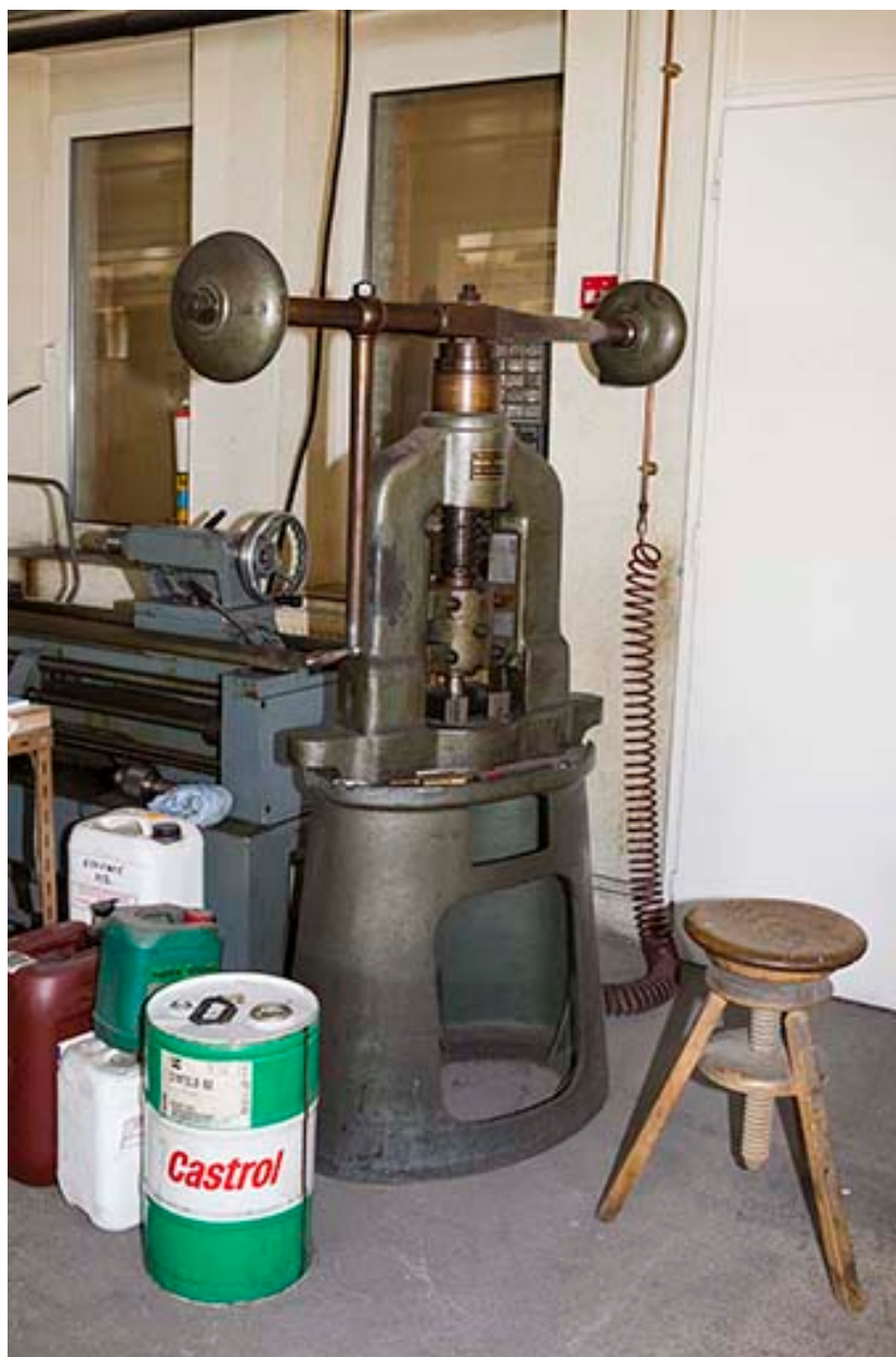
Usine, rez-de-chaussée : grosse presse à balancier.
