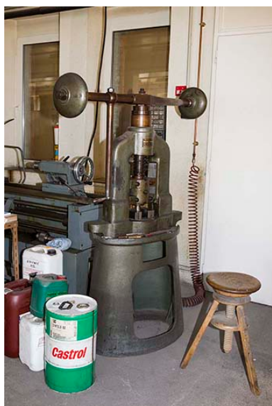
Usine, rez-de-chaussée : grosse presse à balancier.
