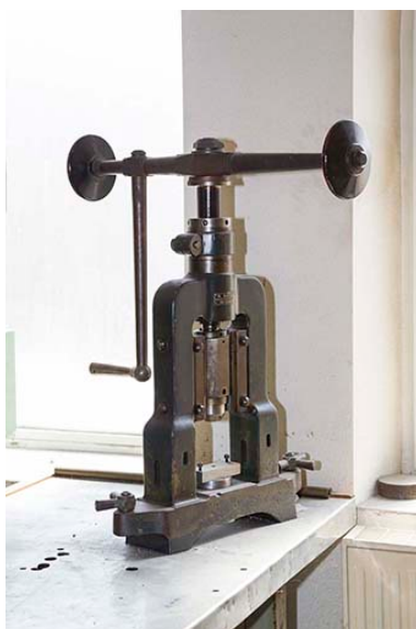
Usine, rez-de-chaussée : petite presse à balancier.
