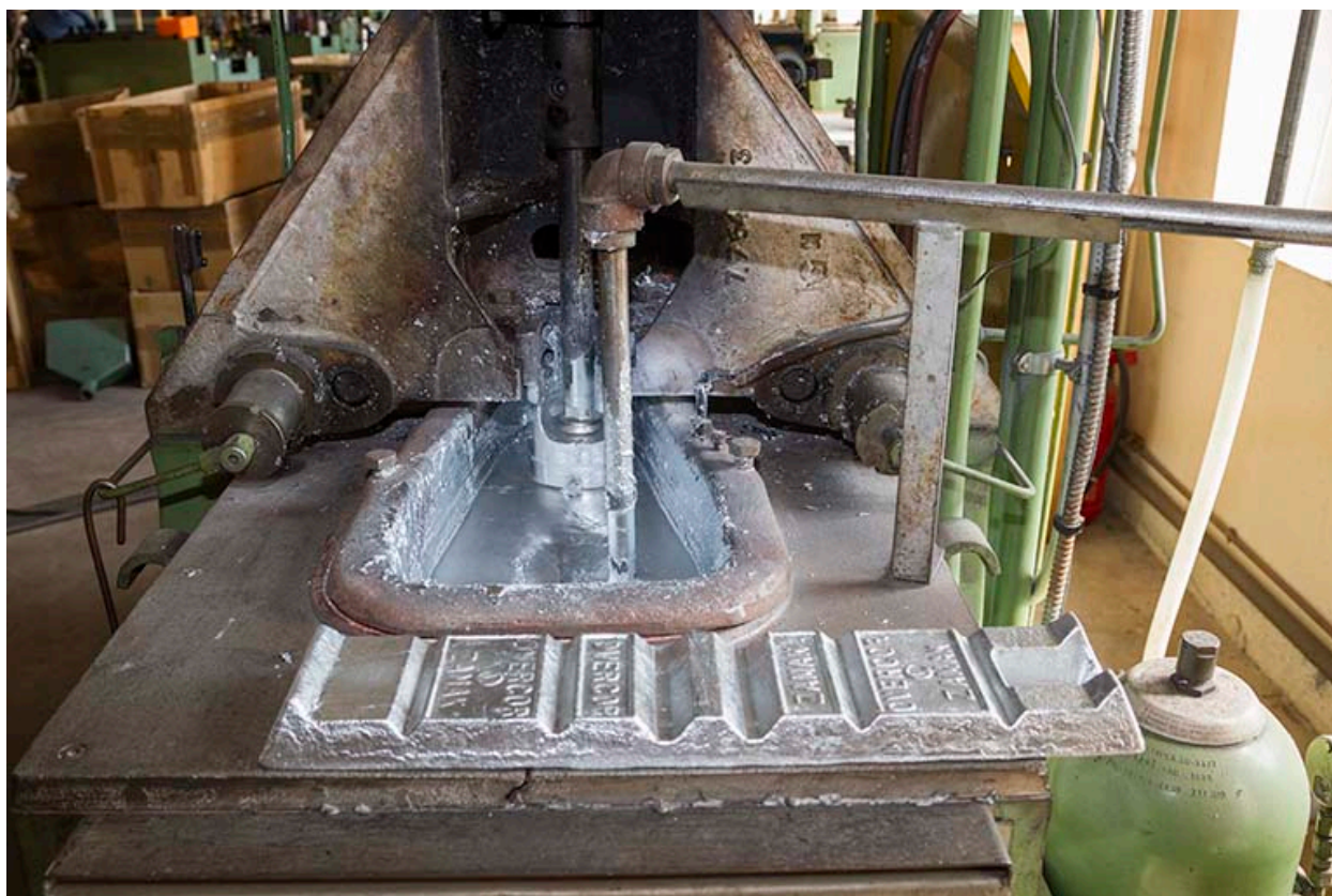
Usine, rez-de-chaussée : machine avec creuset contenant du métal fondu.
