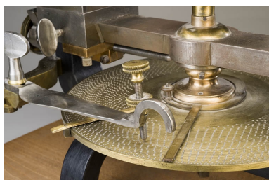
Plateau diviseur, avec son index et son compas mobile. Phot. Marc Loukachine IVR43_20122500083NUC4A
