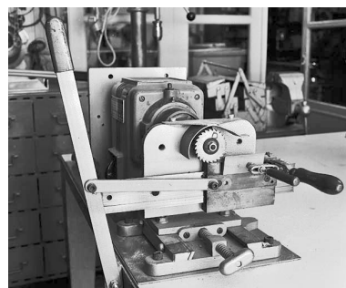
Détail de la fraise (côté fraiseuse). Phot. Jérôme Mongreville IVR43_20003901121X
