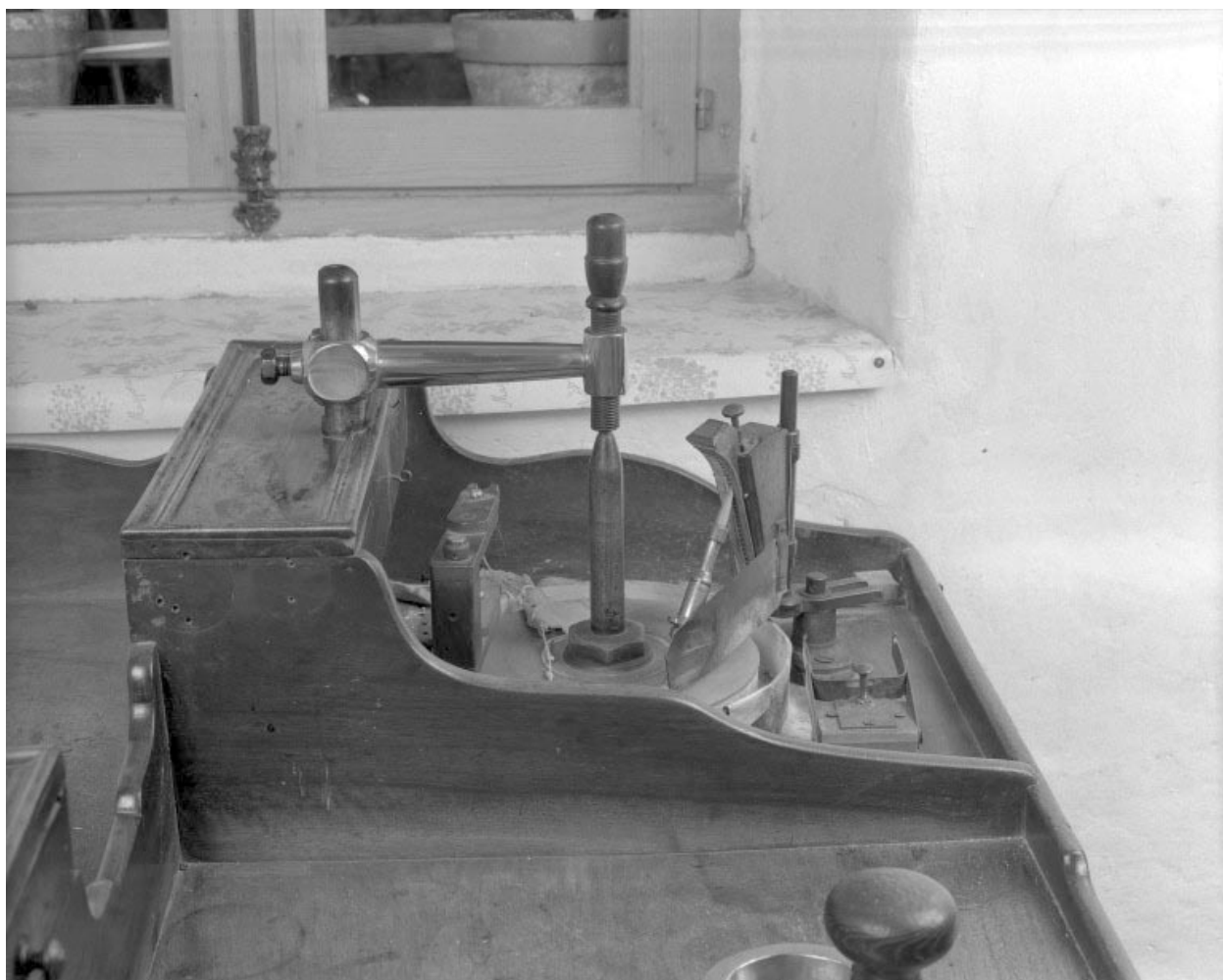
Poste de taille. Le bâton mécanique dans son étui diviseur s'appuie sur l'invention et repose sur la meule.
