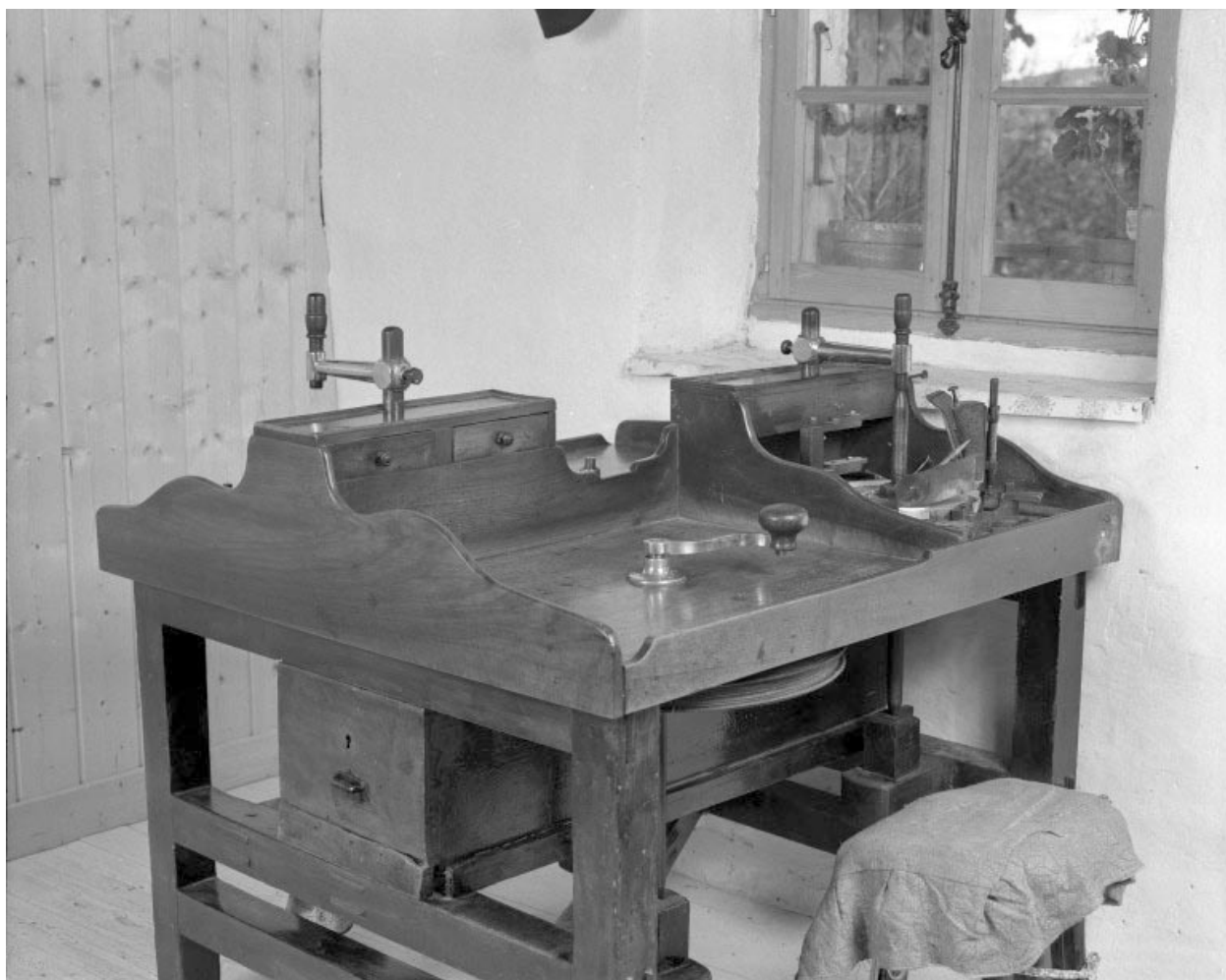
Le plateau et ses 2 postes de travail. Système moteur au premier plan.
