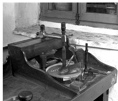
Poste de taille. Le bâton mécanique dans son étui diviseur s'appuie sur l'invention et repose sur la meule. Phot. Jérôme Mongreville IVR43_19943900718X
