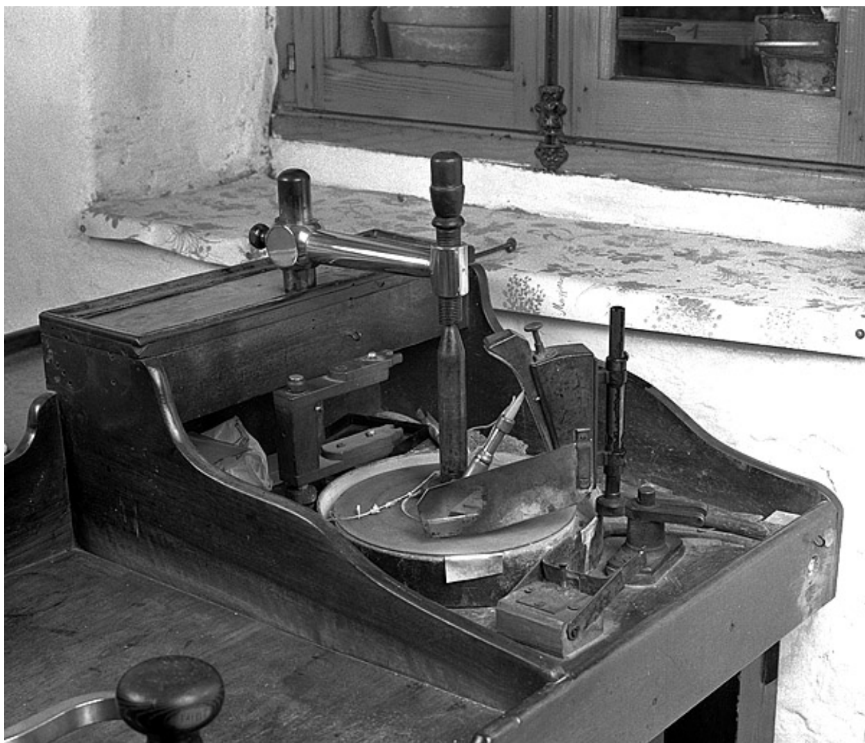
Poste de taille. Le bâton mécanique dans son étui diviseur s'appuie sur l'invention et repose sur la meule.
