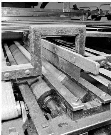
Détail d'un étage de pliage. La feuille est pliée lorsque le bras horizontal (au centre) la fait passer entre les deux rouleaux. Phot. Jérôme Mongreville IVR43_20023900371X
