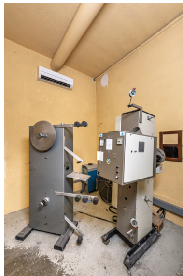
Projecteur argentique Kinoton FP 30 et dérouleur de film. Phot. Pierre-Marie Barbe-Richaud IVR26_20245800246NUC4A
