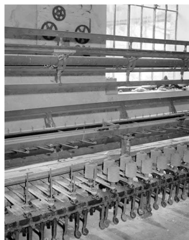
Détail du module de gauche, vu de trois quarts. De bas en haut, système de freinage des broches au pied, broches et leur courrois d'entraînement, système de guidage des fils et moulins. Phot. Yves Sancey IVR43_19943901498X
