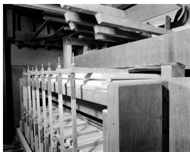
Mécanique, machine Barker, vue de trois quarts gauche. Phot. Jérôme Mongreville IVR43_19852500198X
