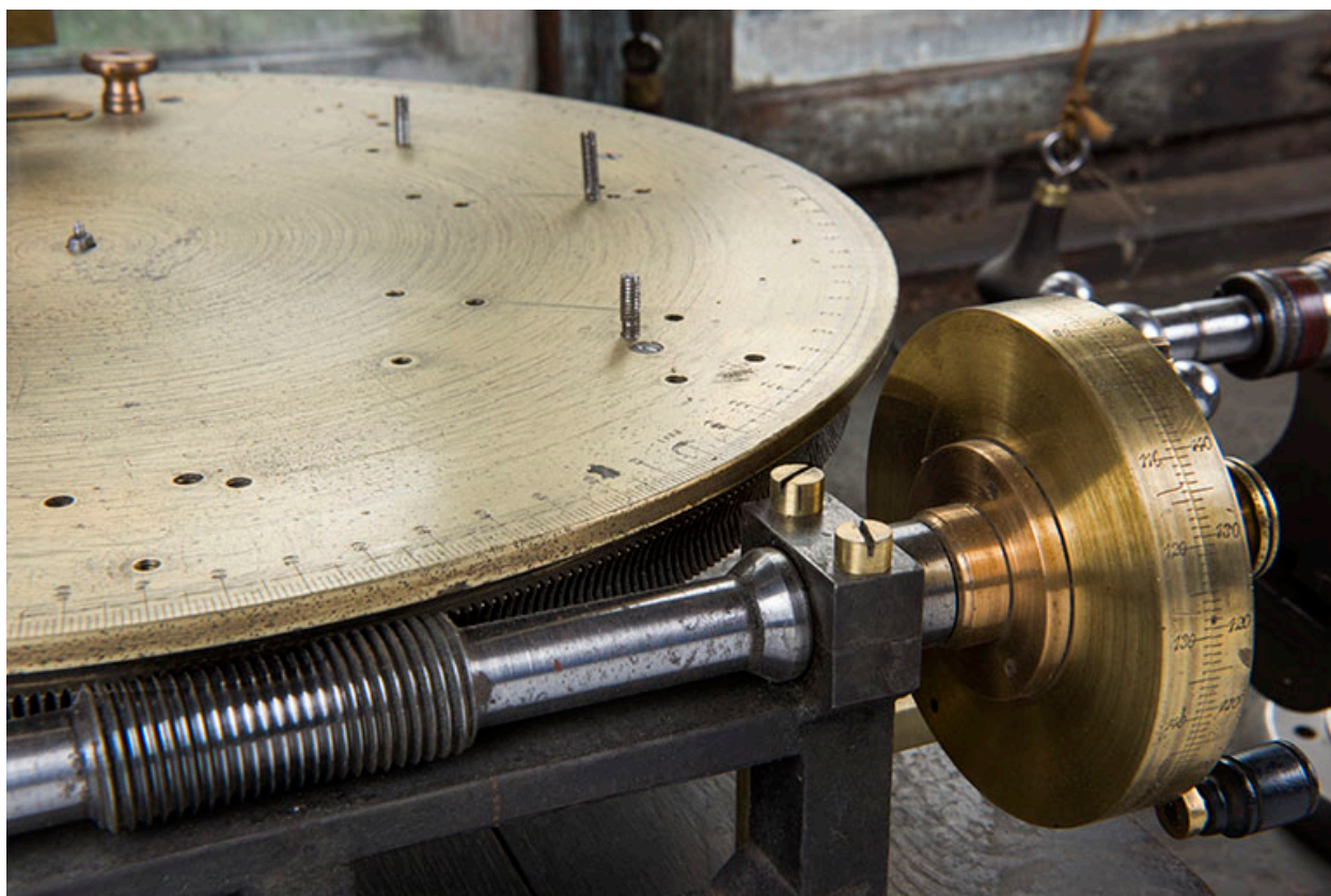
Plateau diviseur : système de mise en rotation.
