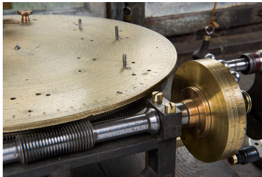
Plateau diviseur : système de mise en rotation. Phot. Sonia Dourlot IVR43_20172500143NUC4A
