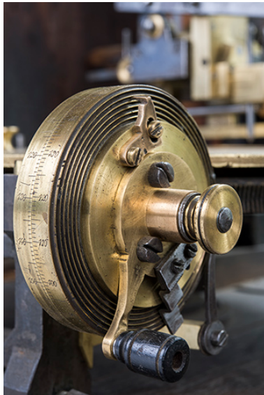
Plateau diviseur : manette et disques gradués du système de mise en rotation. Phot. Sonia Dourlot IVR43_20172500142NUC4A
