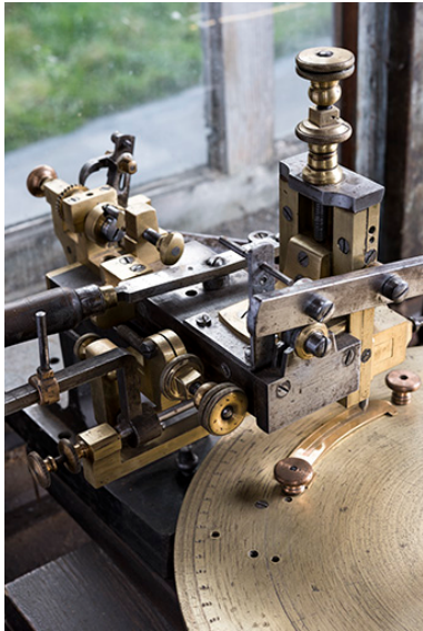
Module de gravage : vue plongeante, de trois quarts gauche. La came réglant la longueur des traits de division est visible à l'arrière-plan.
