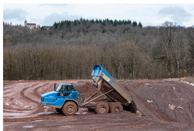
Carrière : évacuation des morts terrains à l'aide d'un camion articulé. Phot. Sonia Dourlot IVR43_20203900022NUC4A
