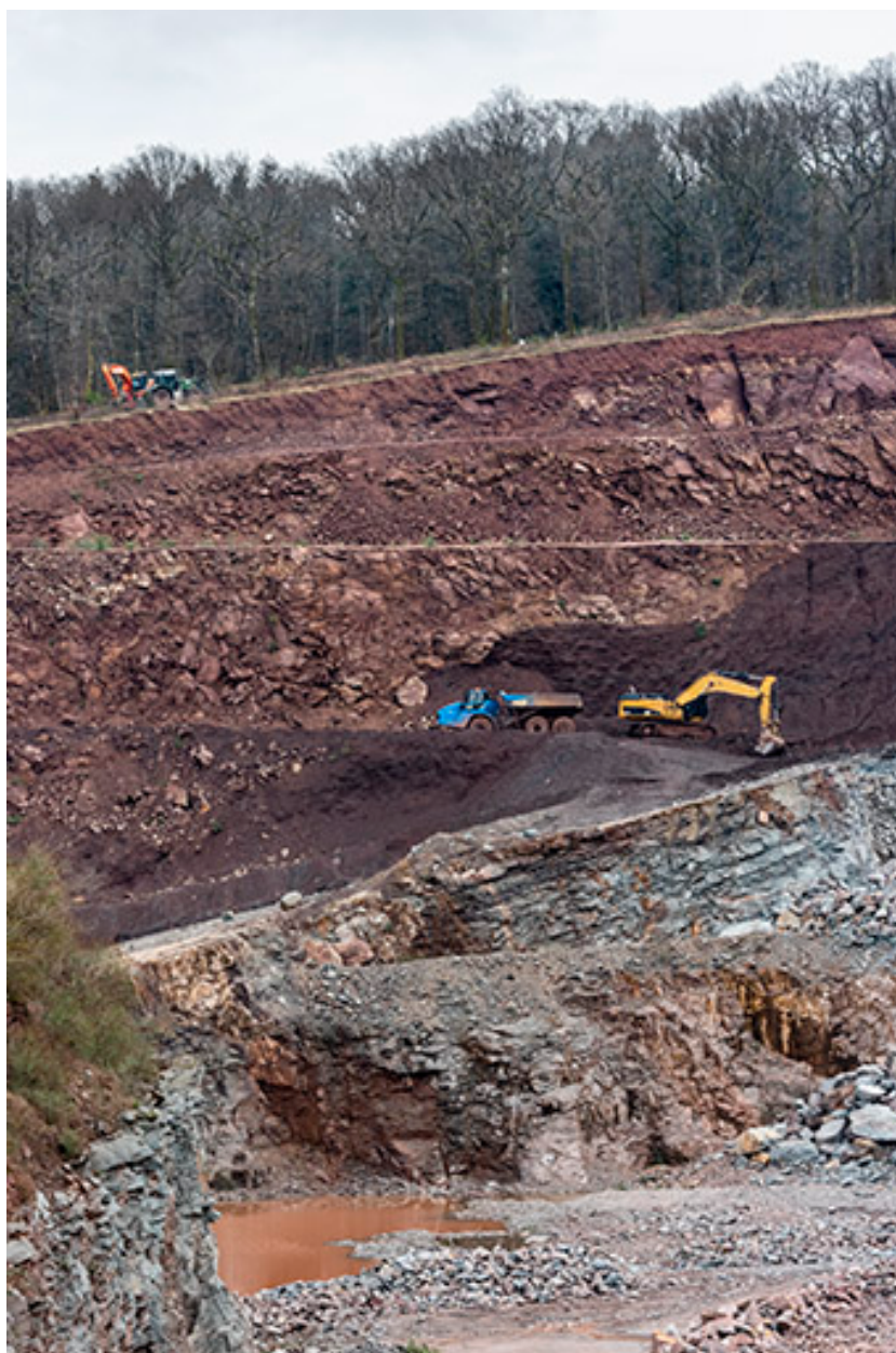
Carrière : découverte à la pelle mécanique.
