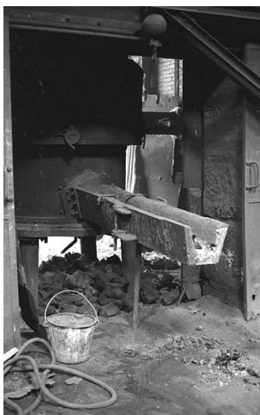
Grand cubilot. Rigole de coulée. Phot. Rémi Hamelin IVR43_20107000033NUC2A
