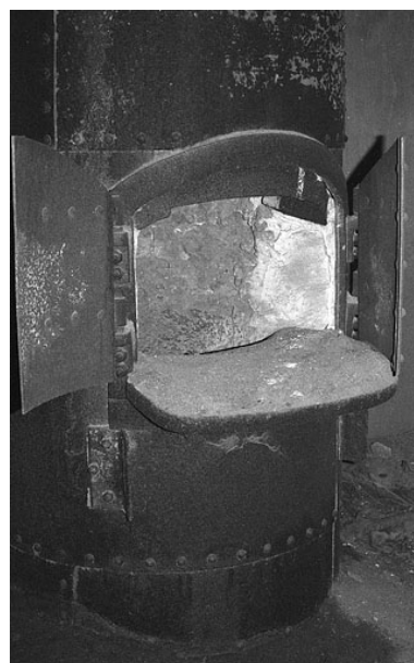
Gueulard du petit cubilot (chargement manuel). Phot. Rémi Hamelin IVR43_20107000025NUC2A
