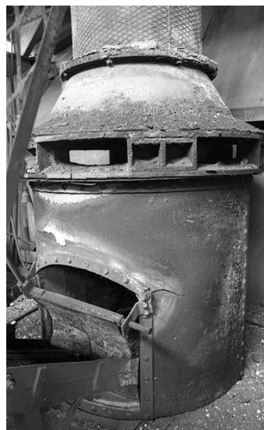
Gueulard (partie supérieure) du grand cubilot (5 tonnes). Phot. Rémi Hamelin IVR43_20107000016NUC2A
