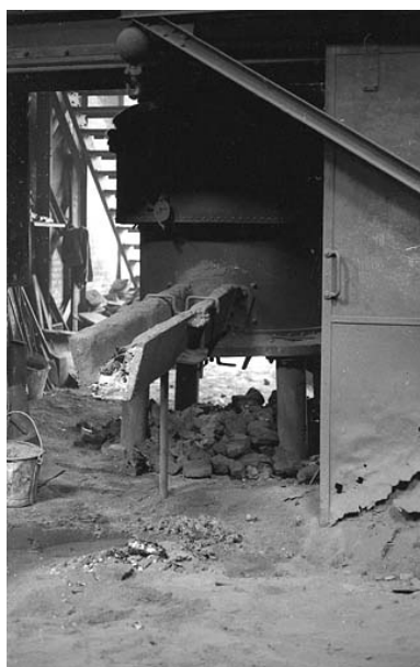
Base du grand cubilot et sa rigole de coulée. Phot. Rémi Hamelin IVR43_20107000040NUC2A
