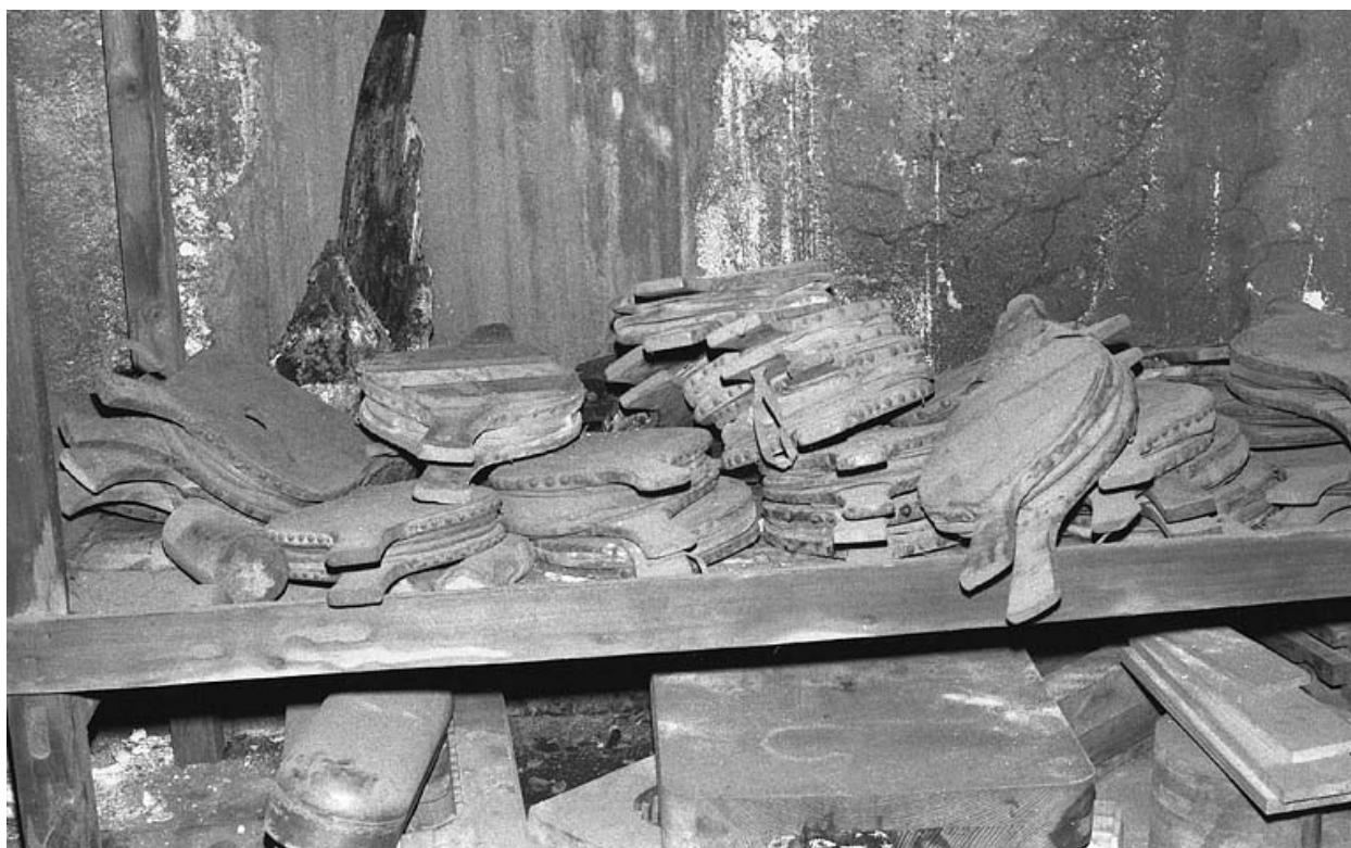
Soufflets de mouleurs (nettoyage des moules).
