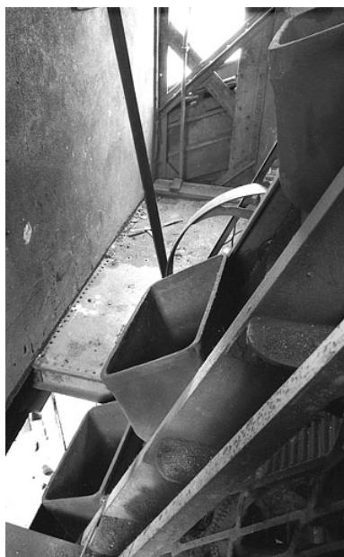
Détail du chargeur à godets du grand cubilot. Phot. Rémi Hamelin IVR43_20107000015NUC2A
