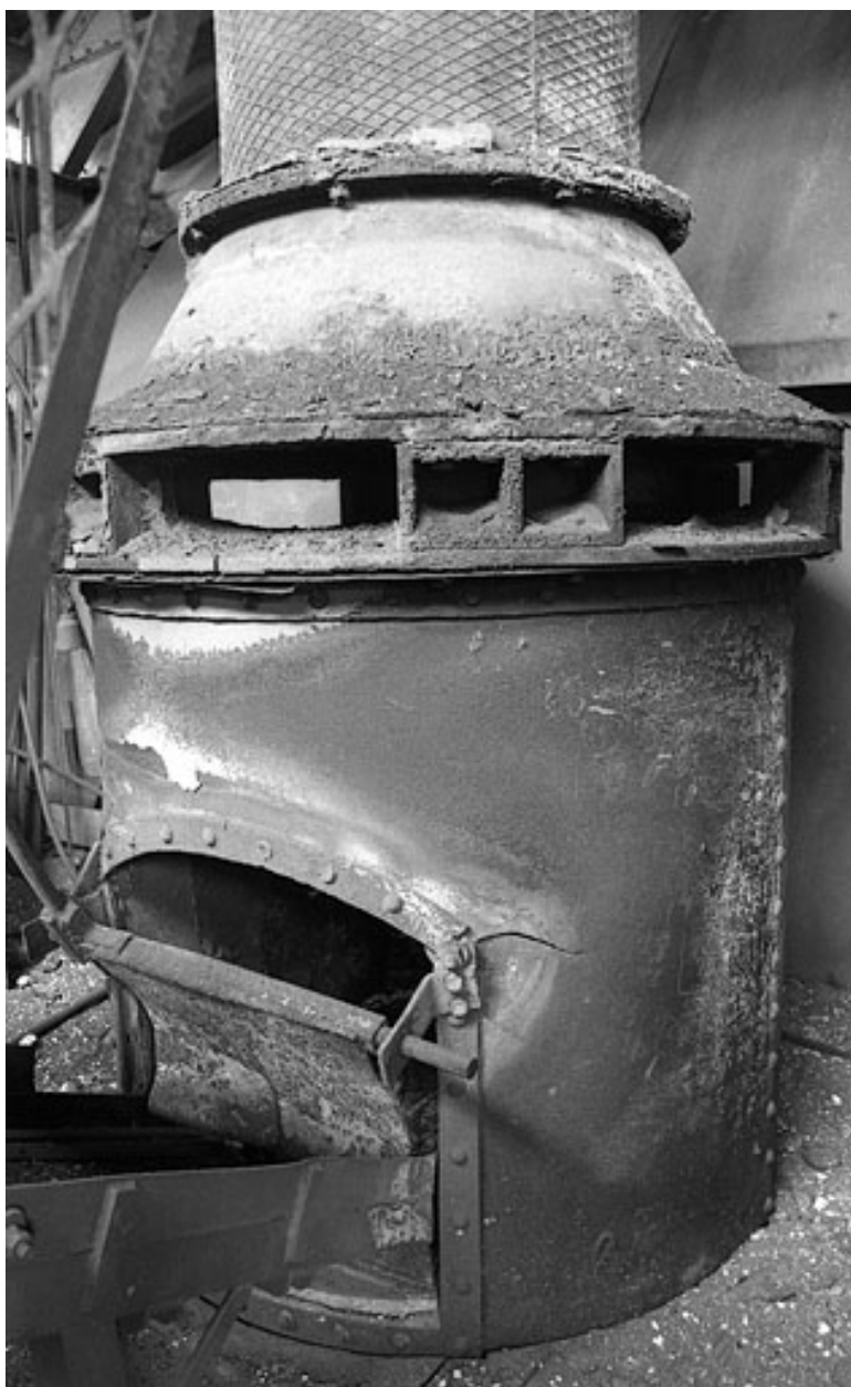
Gueulard (partie supérieure) du grand cubilot (5 tonnes).
