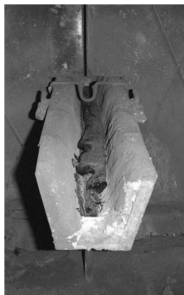
Grand cubilot. Détail de la rigole de coulée. Phot. Rémi Hamelin IVR43_20107000043NUC2A
