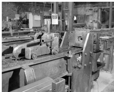
Banc d'étirage : chariot et filière. Phot. Yves Sancey IVR43_19923900913X
