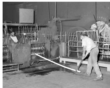
Laminoir : billeterie en cage de dégrossis. Phot. Yves Sancey IVR43_19923900948X
