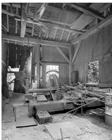
Engrenages de l'ancienne turbine du laminoir. Phot. Yves Sancey IVR43_19923900901X
