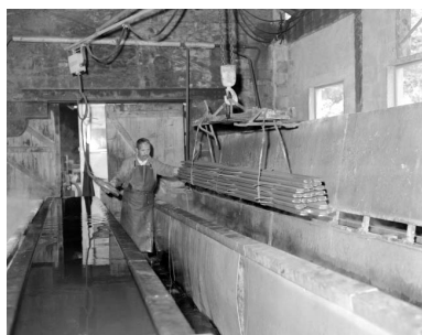
Atelier de décapage : déplacement des barres. Phot. Yves Sancey IVR43_19923900976X
