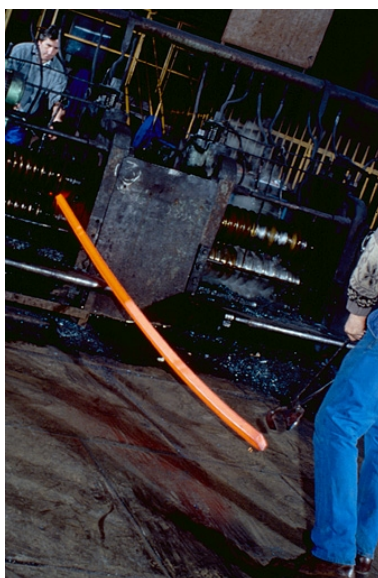
Laminoir : travail en cage de carré. Phot. Yves Sancey IVR43_19943900227ZA
