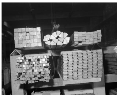
Atelier d'étirage : détail de quelques sections de profilés. Phot. Yves Sancey IVR43_19953901177X
