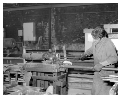
Atelier de pose des soies : chauffage des barres. Phot. Laurent Poupard IVR43_19923900981ZA
