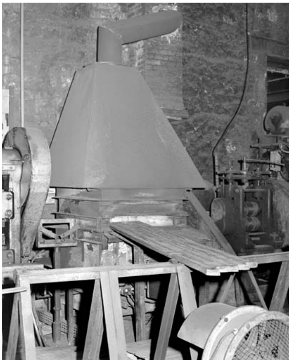
Atelier de préparation des soies : four.
