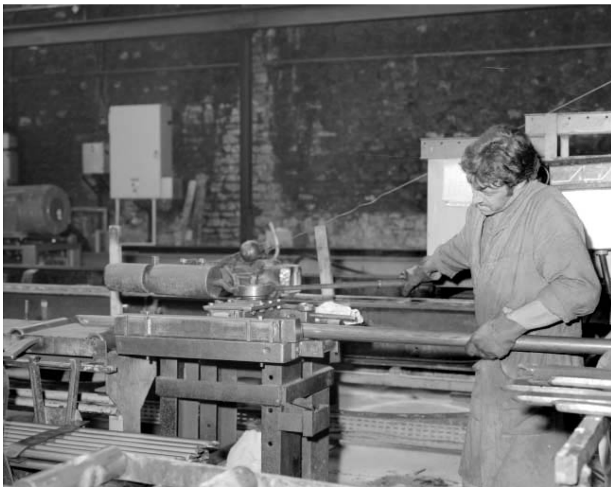
Atelier d'étirage : redressage d'une barre d'acier.
