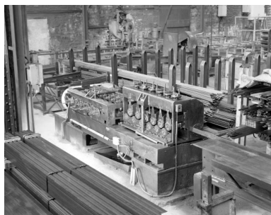
Machine à redresser de l'Office Technique des Profilés. Phot. Yves Sancey IVR43_19923900916X
