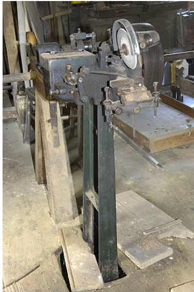
Premier étage. Tour à meuler. Phot. Jérôme Mongreville IVR43_20057000256NUCA
