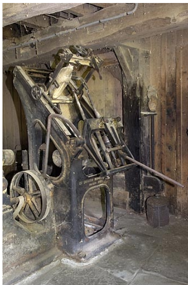
Rez-de-chaussée. Tour à cuillères (videuse) Bonneau & Schwartz et Cie. Phot. Jérôme Mongreville IVR43_20057000252NUCA
