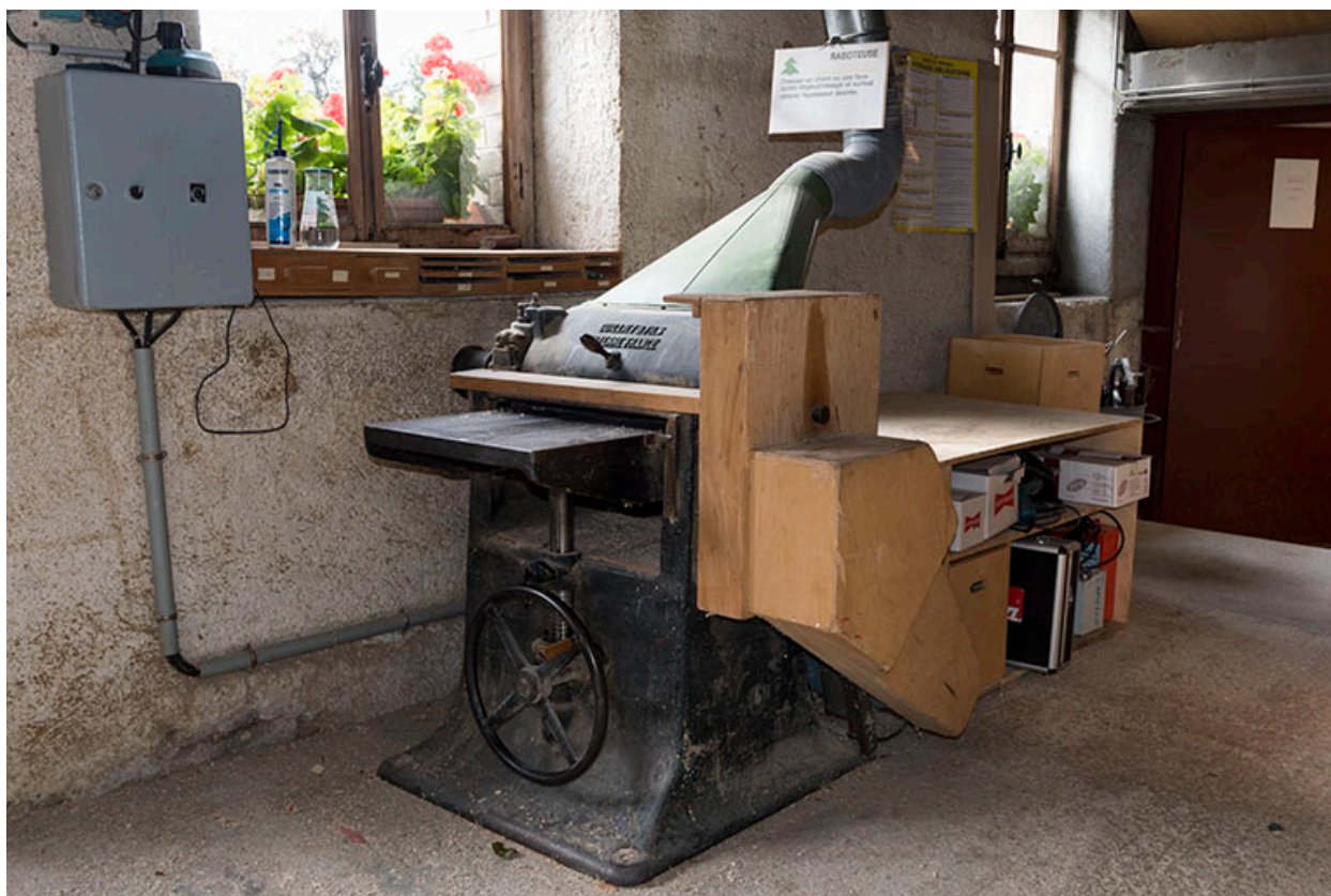
Atelier de fabrication : raboteuse Guilliet.
