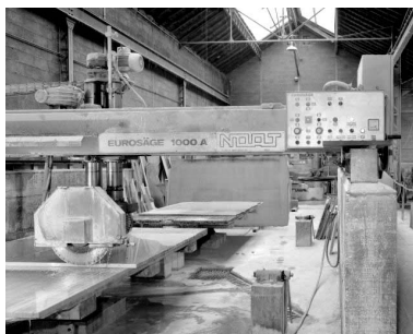
Lame circulaire et armoire de commande. Phot. Yves Sancey IVR43_19933900352X
