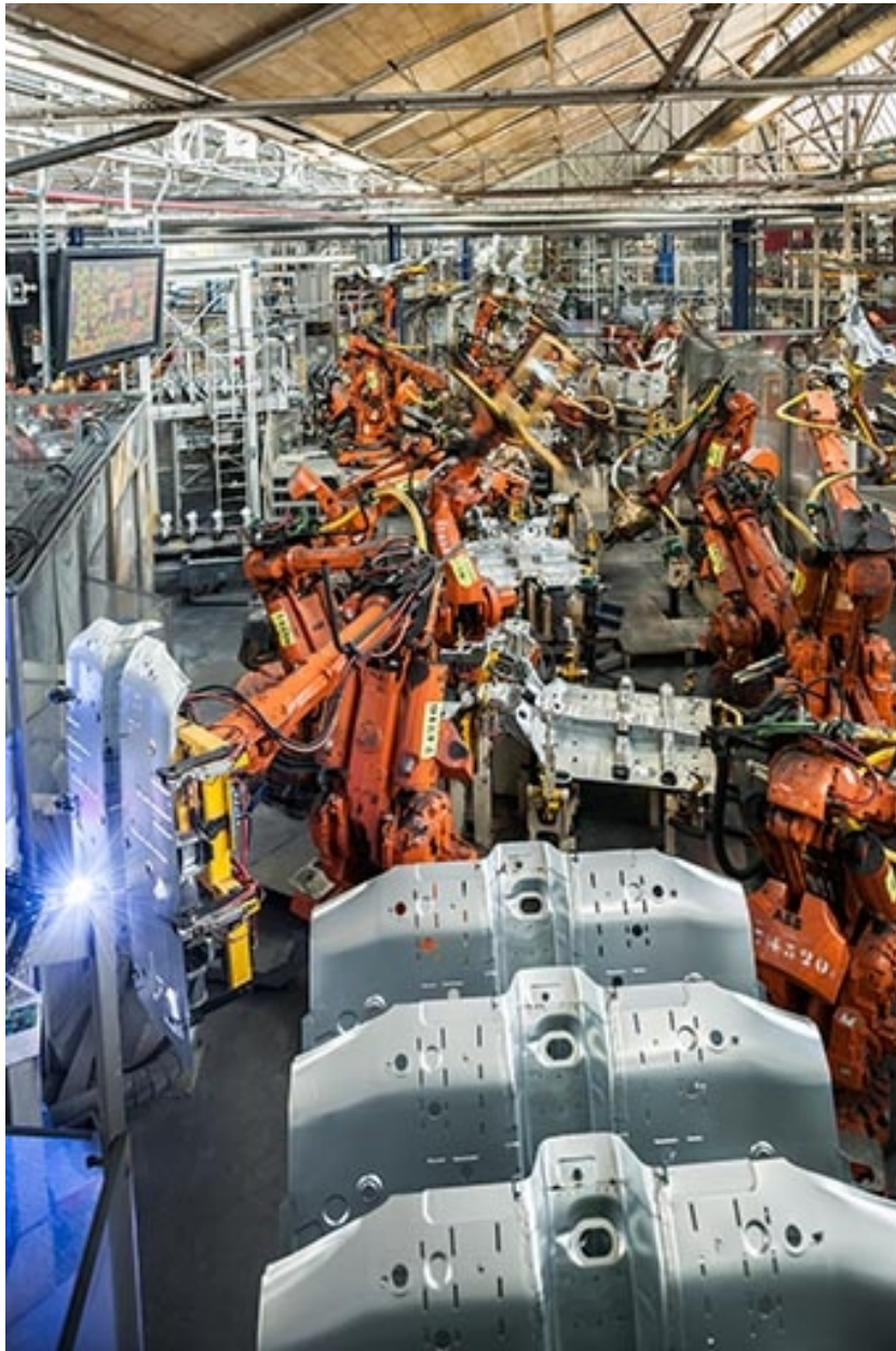
Atelier de ferrage. Soudage des pièces de la caisse en blanc dans un îlot robotisé (3).
