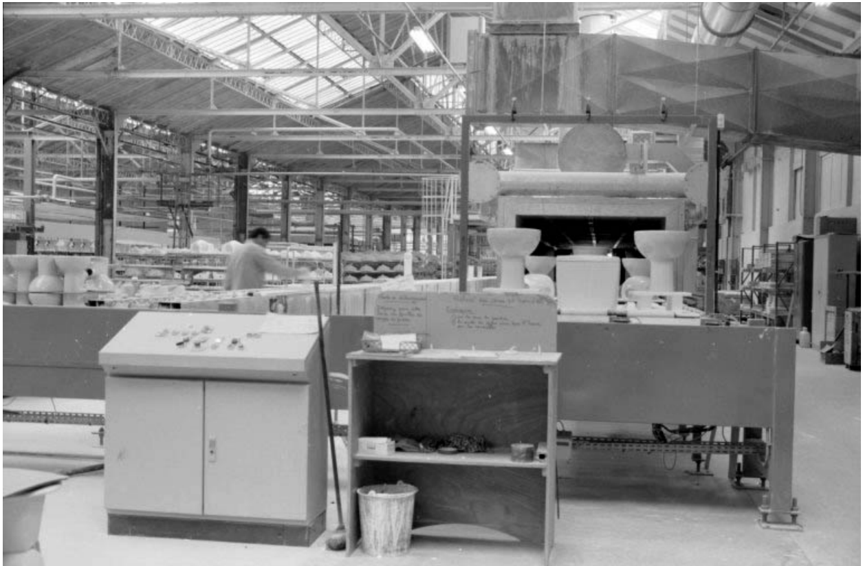
Atelier (9) : arrière du four Riedhammer.
