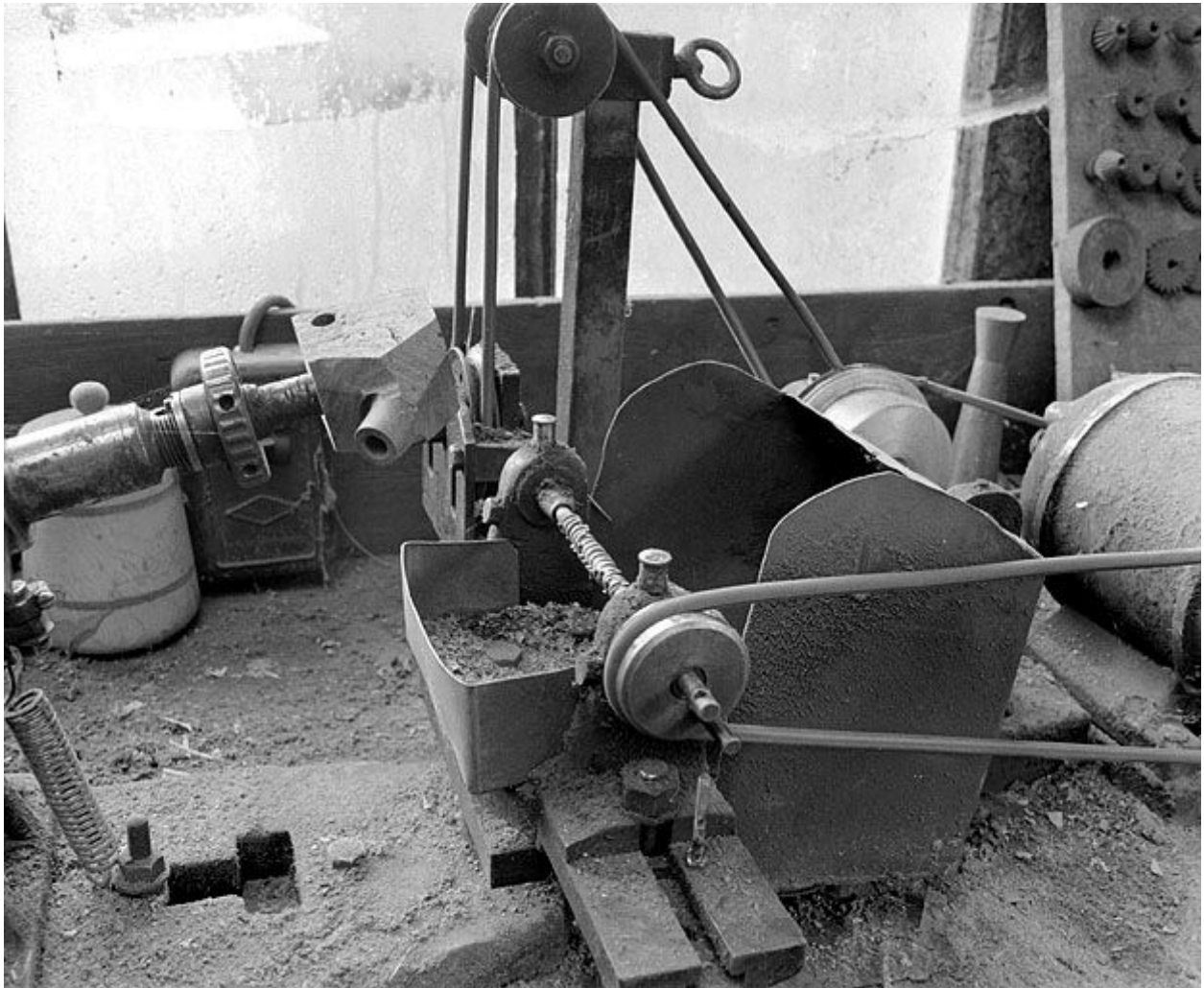
Vue d'ensemble de la partie droite : arbre cranté horizontal faisant office de fraise.
