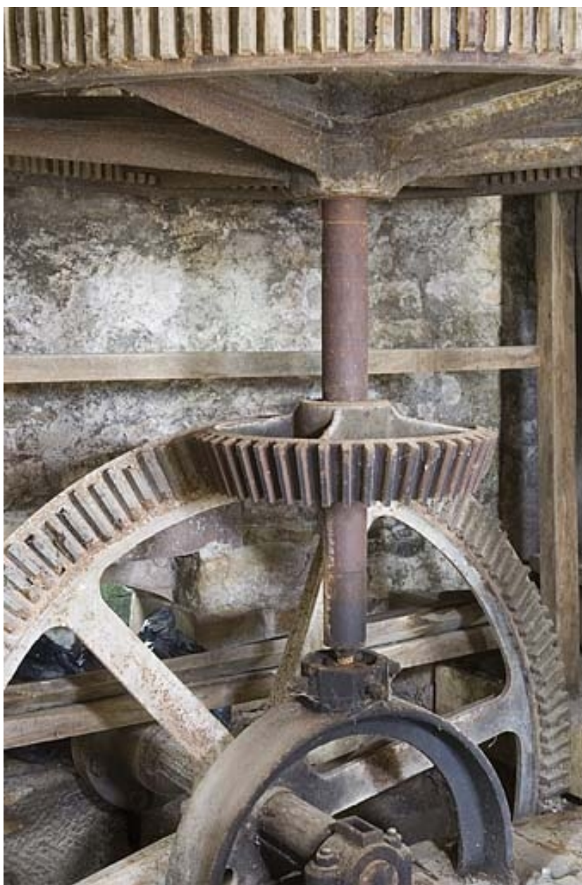
Détail des engrenages du beffroi.
