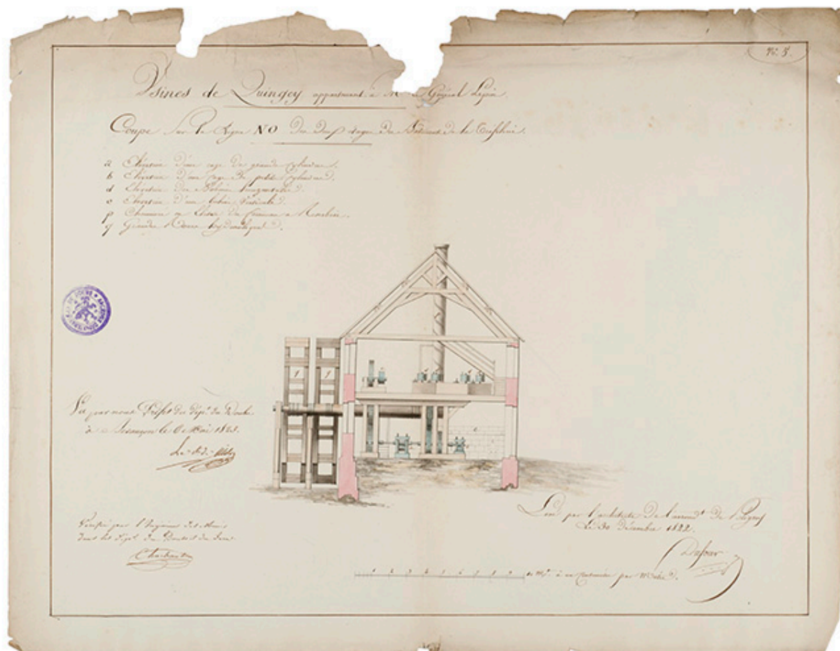
Usines de Quingey [...]. Coupe sur la ligne NO des deux étages du bâtiment de la tréfilerie [...], 1822.
