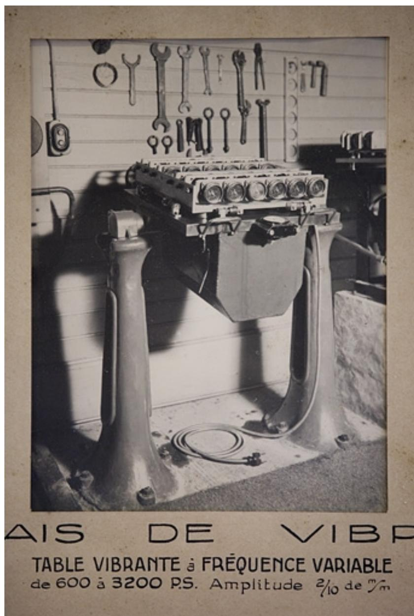
Essais de vibrations. Table vibrante à fréquence variable de 600 à 3200 P.S. Amplitude  $\frac{2}{10}$  de m/m, entre 1932 et 1934.
