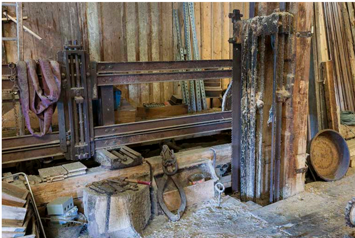
Scierie Thiébaud, Labergement-Sainte-Marie : châssis de scie monolame ("sabre").
