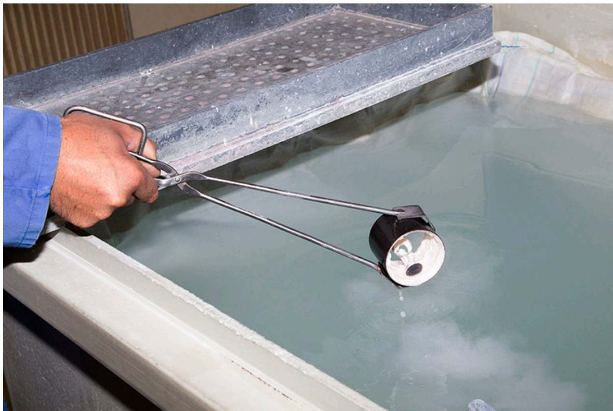
Fonte à la cire perdue : état du moule après trempage dans l'eau.
