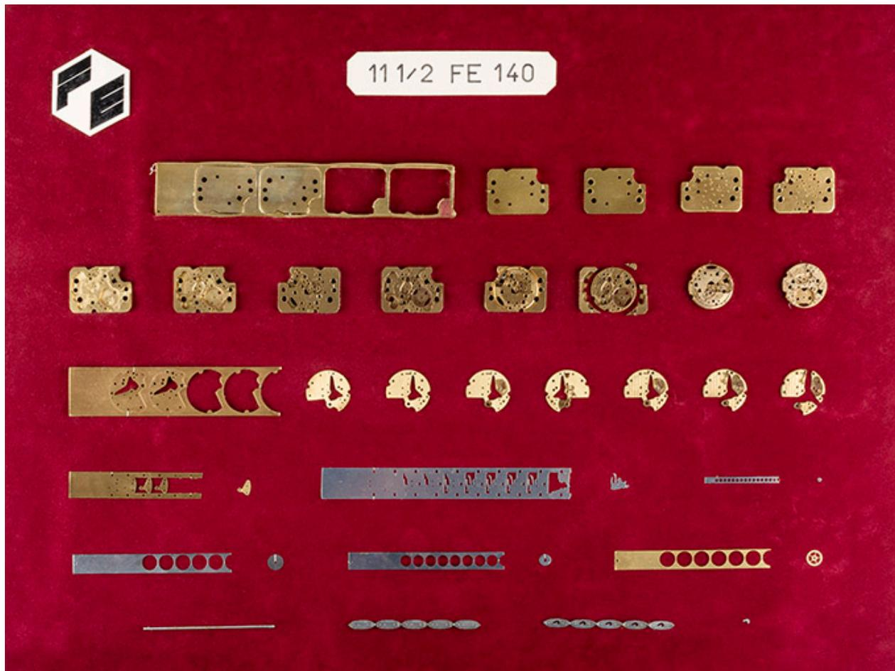
Phases de fabrication de composants d'un mouvement FE 140. (Collection musée de l'Horlogerie, Morteau).
