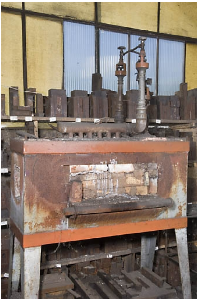
Atelier est. Four à gaz Thermidor.
