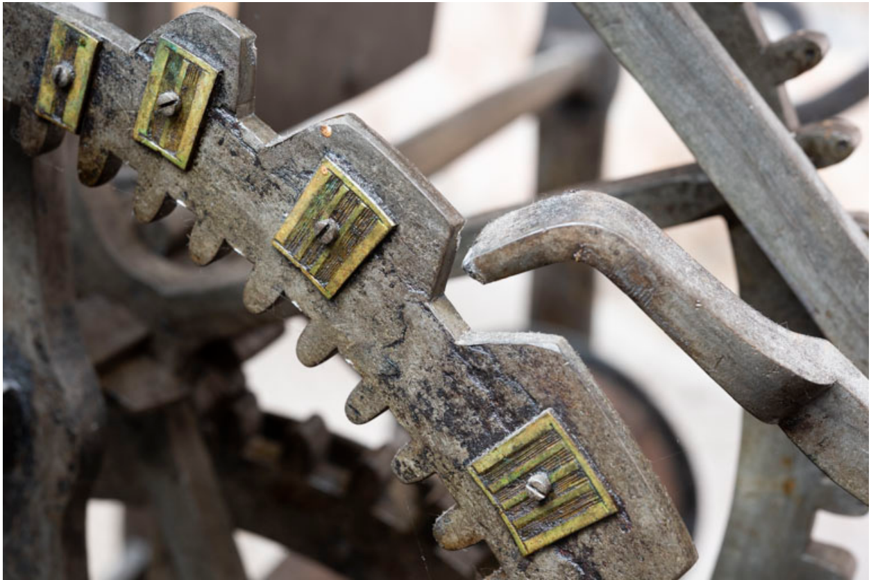
Corps avant gauche (sonnerie des heures) : détail de la roue de compte.
