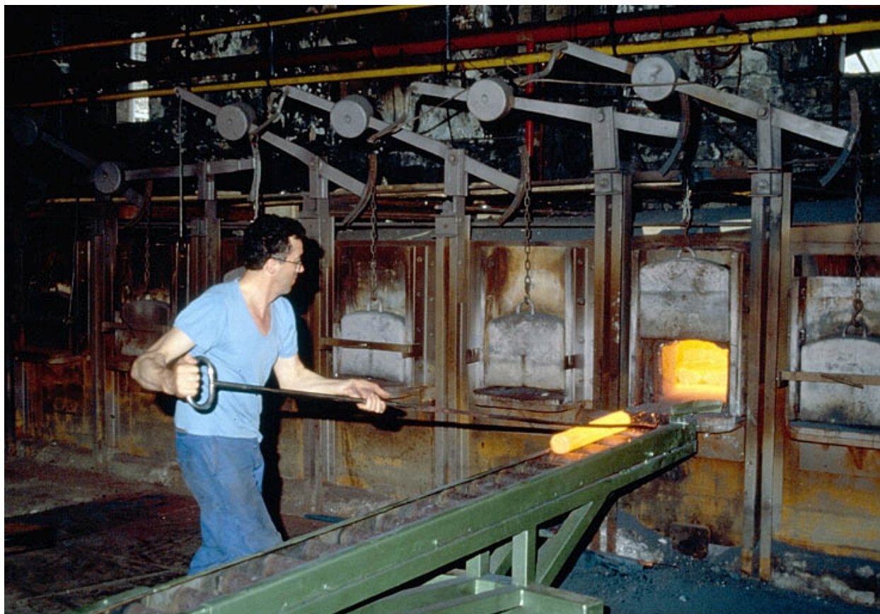
Défournement d'une billette.
