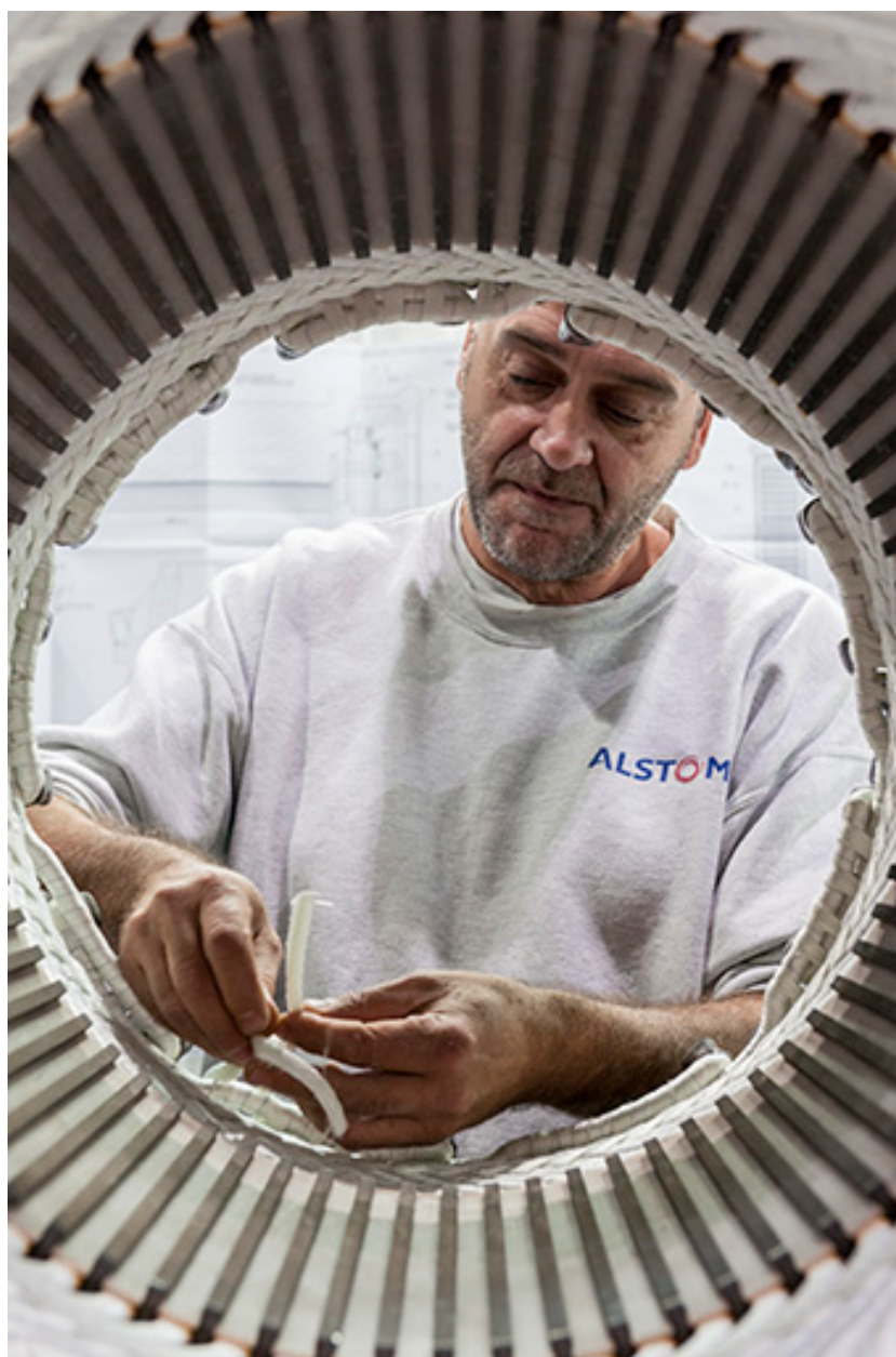
Atelier de bobinage. Montage des barres de cuivre.
