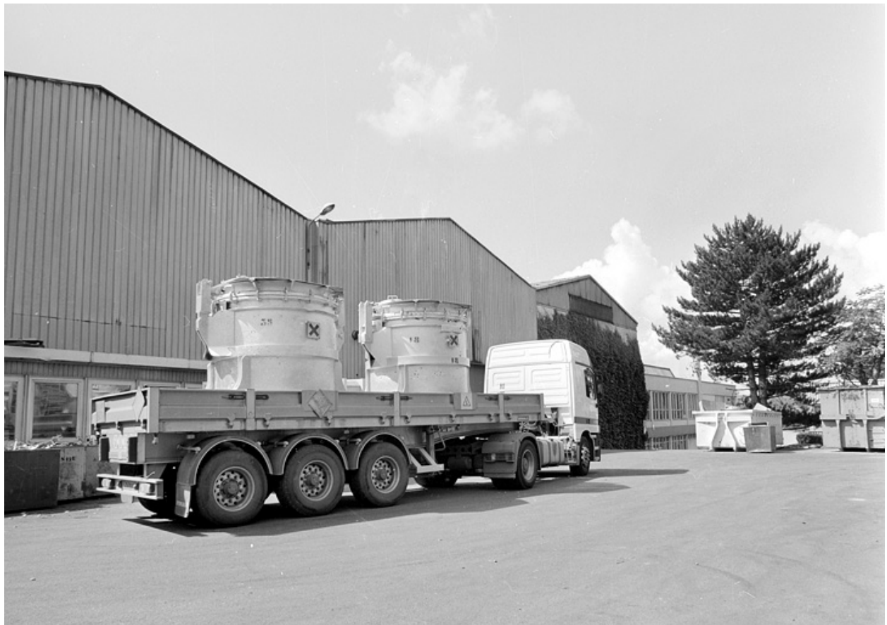
Camion manoeuvrant pour aller décharger les poches d'aluminium liquide.
