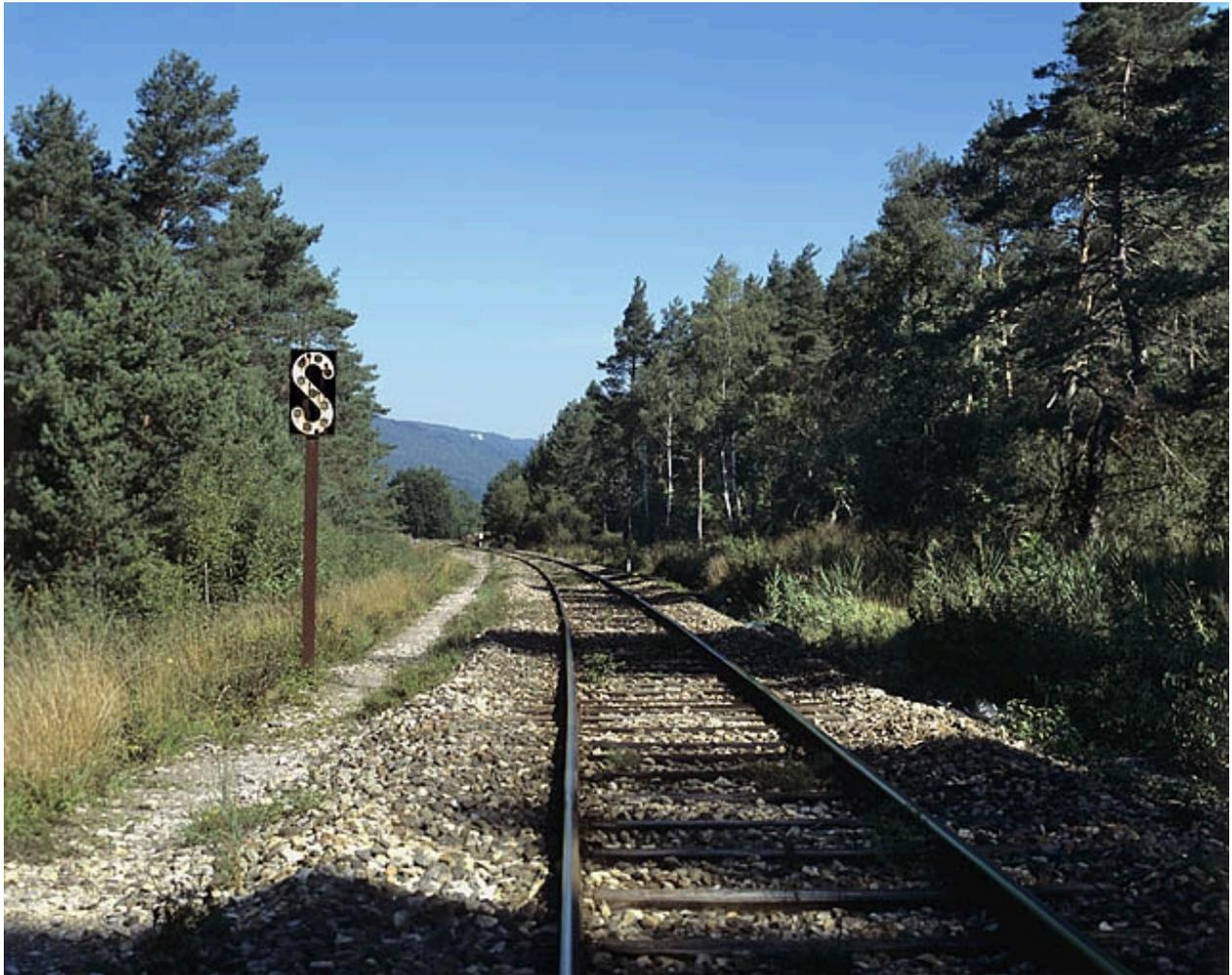
Panneau S annonçant le passage à niveau. Le panneau S impose au mécanicien de siffler (en général avant un passage à niveau non gardé).
