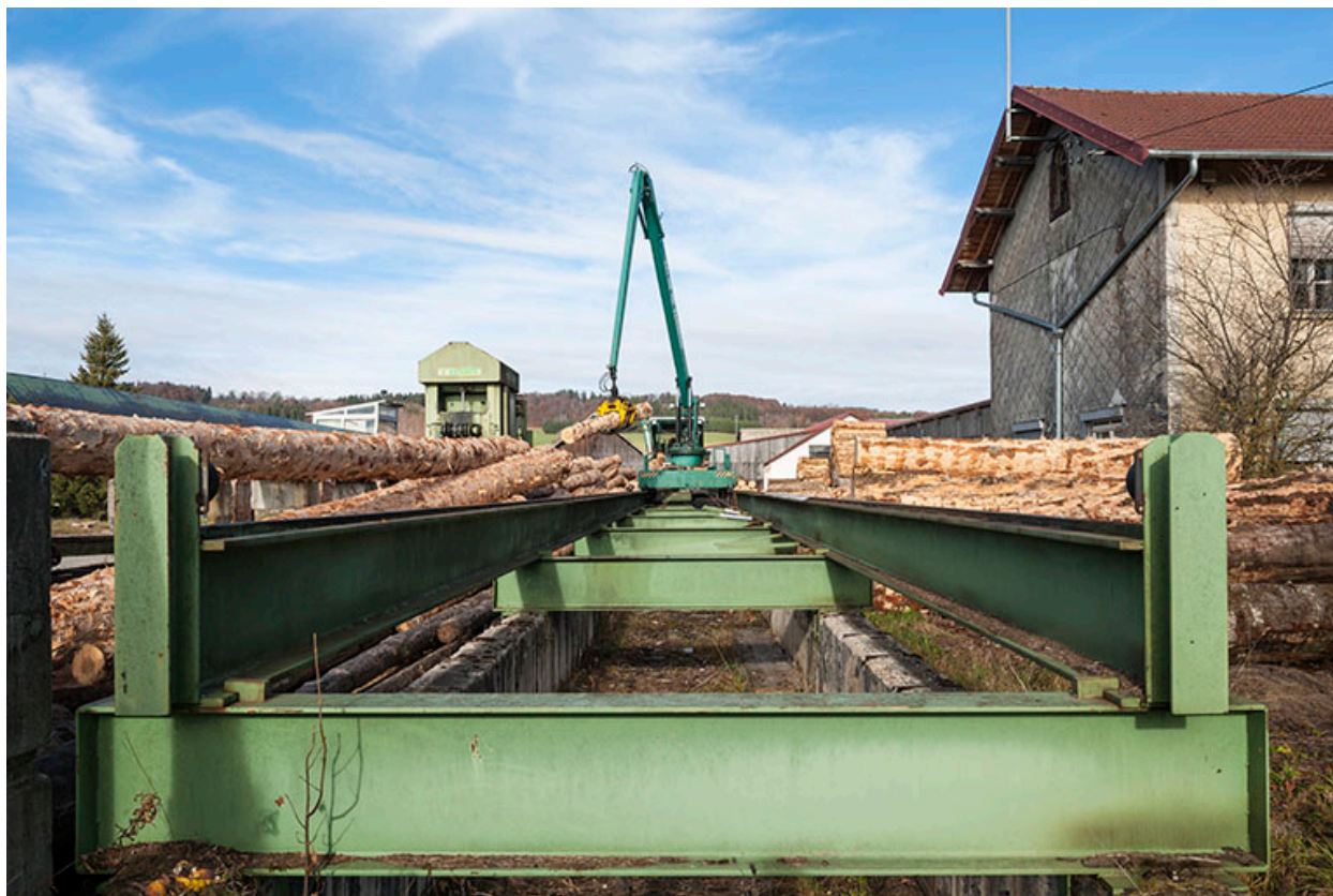
Chariot sur rail du poste d'écorçage.
