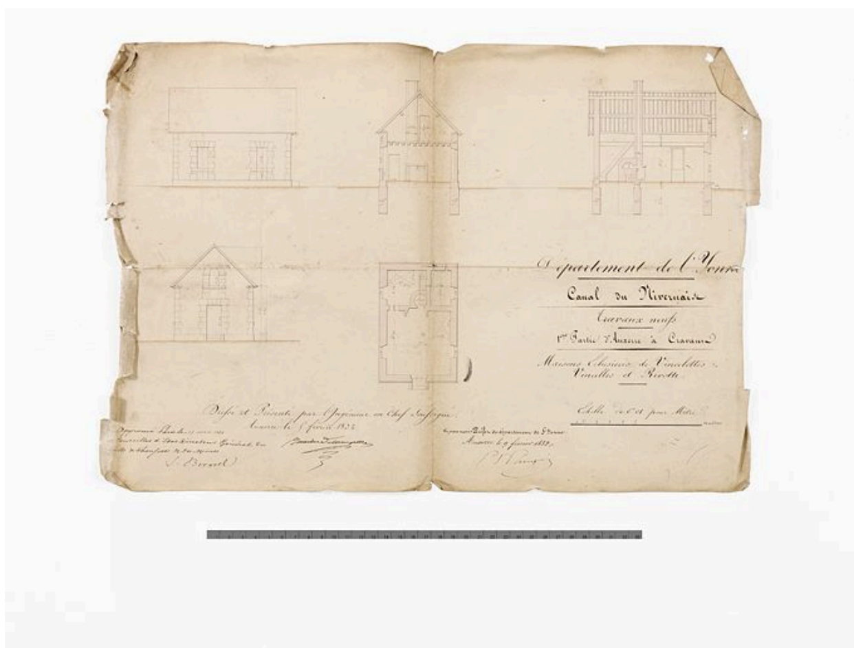
"Maisons éclusières de Vincelottes, Vincelles et Rivotte". Elévation, plan et coupe. (VNF-direction territoriale Centre-Bourgogne ; subdivision de Corbigny)
