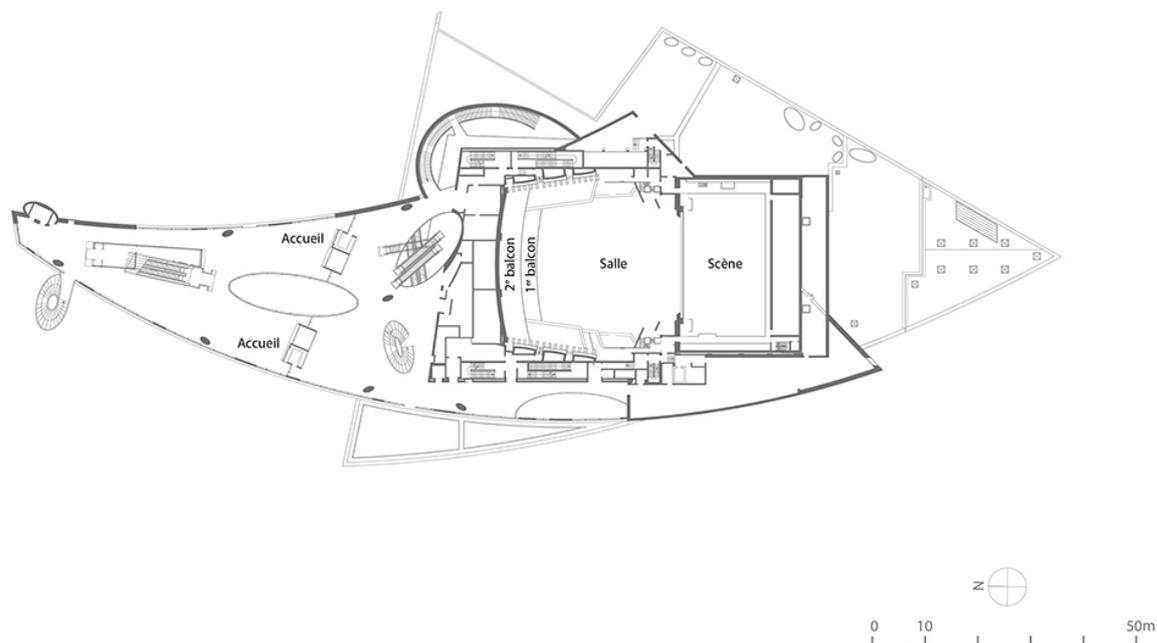
Plan au 3e étage (niveau 12,60 m). D'après un plan non daté fourni par l'Opéra de Dijon.
