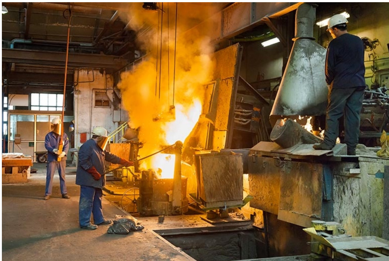
Basculer d'un four à induction dans une poche.
