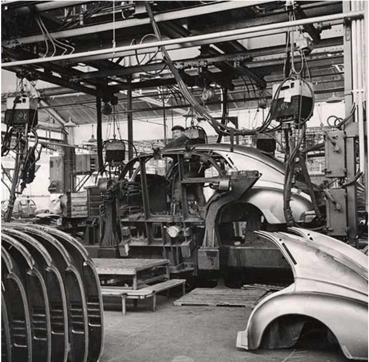
Assemblage de la caisse par soudure électrique.
