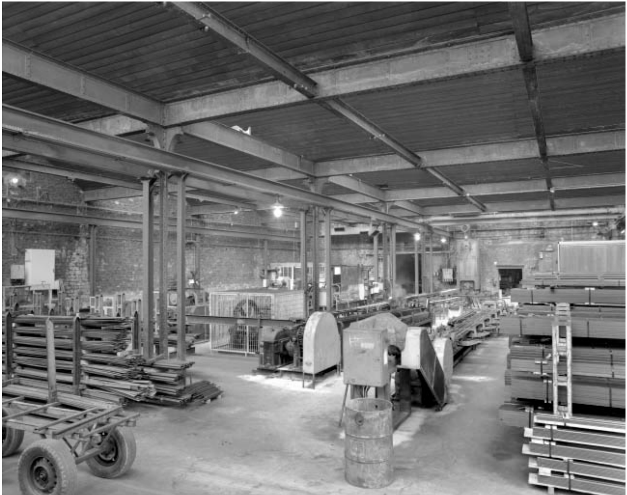
Intérieur de l'atelier d'étirage : bancs d'étirage.
