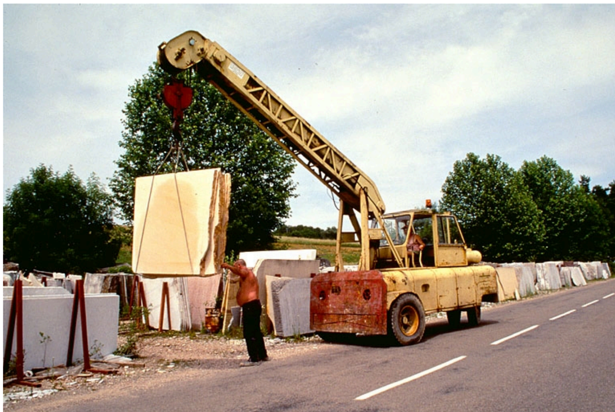
Usine de taille de matériaux de construction Yelmini Artaud, à Balanod : transport de tranches de marbre avec la grue automotrice Belotti.
