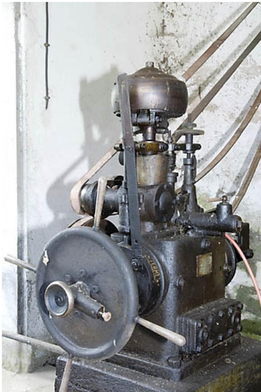
Rez-de-chaussée. Détail du multiplicateur Goulut-Borne.
