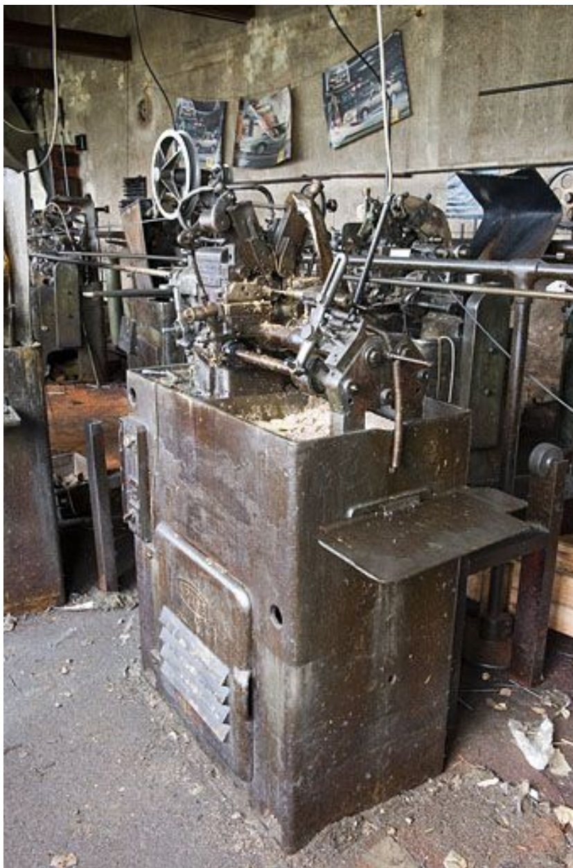
Atelier primitif. Machine à décolleter.
