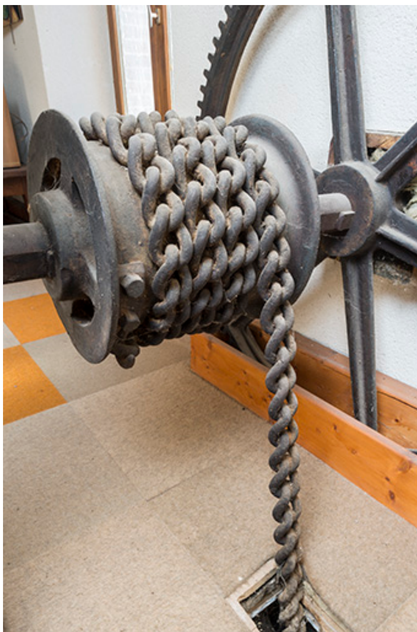
Système de levage de la roue suspendue (aval). Détail du mécanisme d'enroulement de la chaîne.
