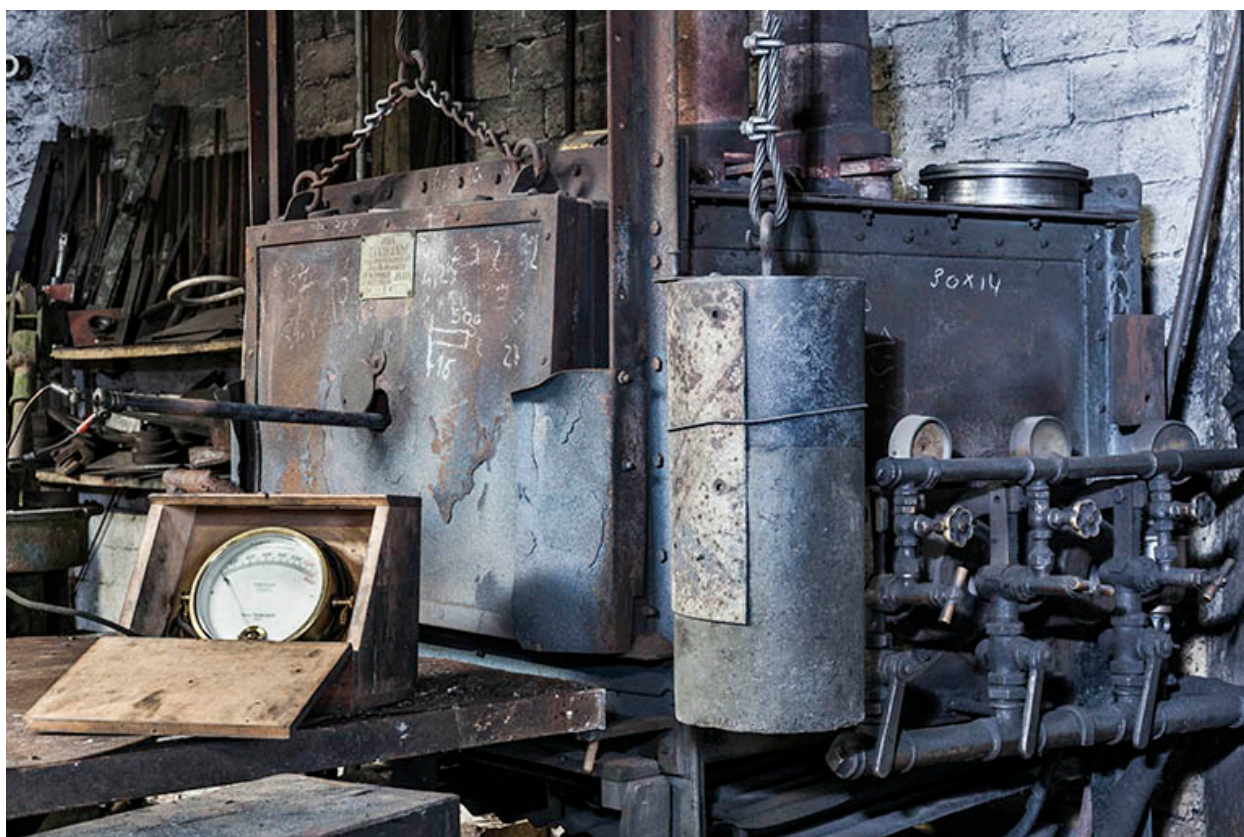
Four à fuel de marque Tranchant (Paris). Au premier plan : pyromètre et sa sonde.
